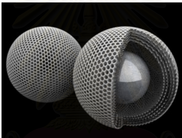
รูปที่ 2.5 แคปซูลนาโนคาร์บอน (Carbon nanocapsules, CNCs)
