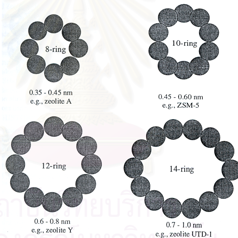
รูปที่ 2.17 รูพรุนขนาดต่าง ๆ ของซีโอไลต์กำหนดโดยการจัดเรียงตัวของอะตอมออกซิเจน [11].
