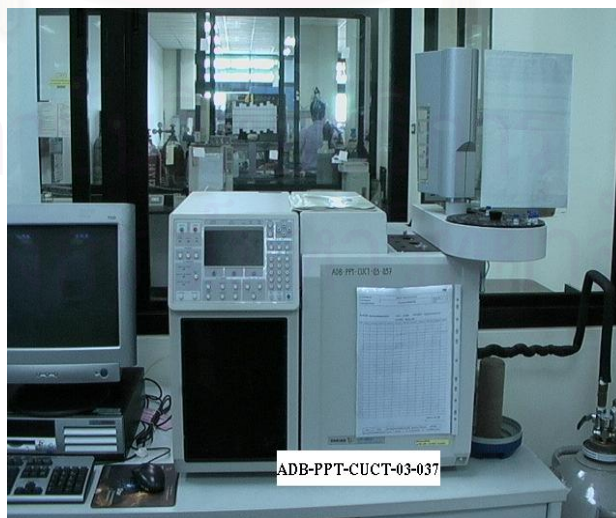
รูปที่ 3.1 เครื่องแก๊สโครมาโทกราฟี รุ่น CP-3800 ของ VARIAN.
