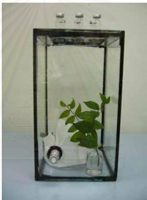
รูปที่ 4.7 แชมเบอร์แก้วขนาด 20 x 20 x 35 เซนติเมตร ที่บรรจุกิ่งไม้ น้ำหนัก 10 กรัม
