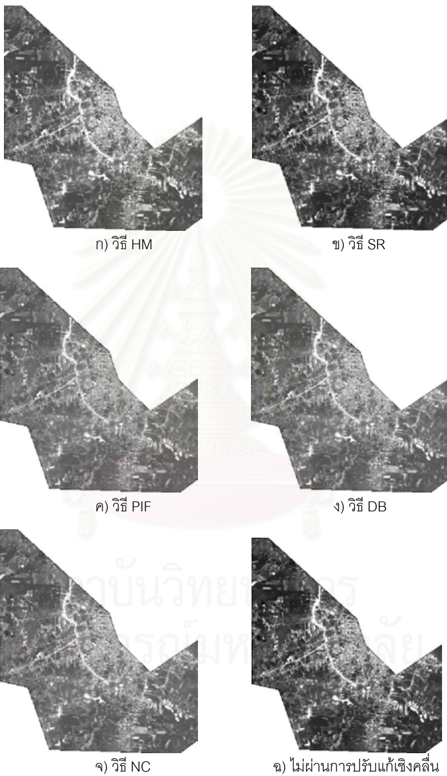
รูปที่ ข.4 ข้อมูลภาพถ่ายดาวเทียมที่ผ่านการปรับแก้เชิงคลื่นด้วยวิธีต่างๆ พื้นที่ จ.สงขลา (แบนด์สี่เขียว)
