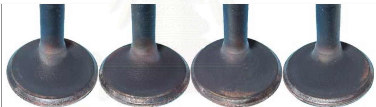
รูปที่ 5-96 แสดงภาพถ่ายวาล์วไอเสียจากที่ใช้ น้ำมันดีเซล
