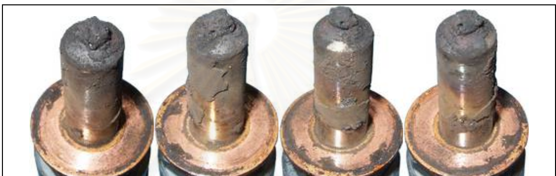
รูปที่ 5-103 แสดงภาพถ่ายหัวฉีดจากเครื่องยนต์ที่ใช้น้ำมันปาล์มไบโอดีเซล
