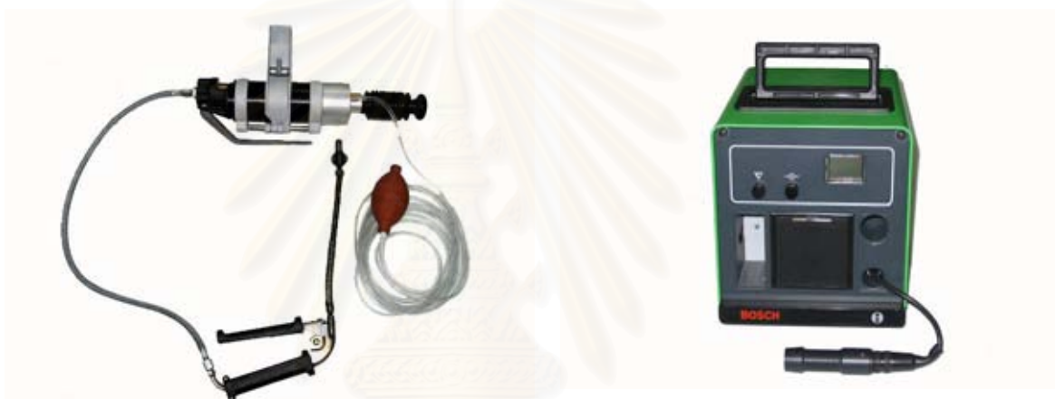
รูปที่ 4-29 ชุดเครื่องมือวัดค่าควันดำ ภาพซ้าย แสดงภาพบั๊มดูดไอเสีย รุ่น ETD 020.00 ภาพขวา แสดงภาพ เครื่องอ่านค่าควันดำ รุ่น ETD 020.50
