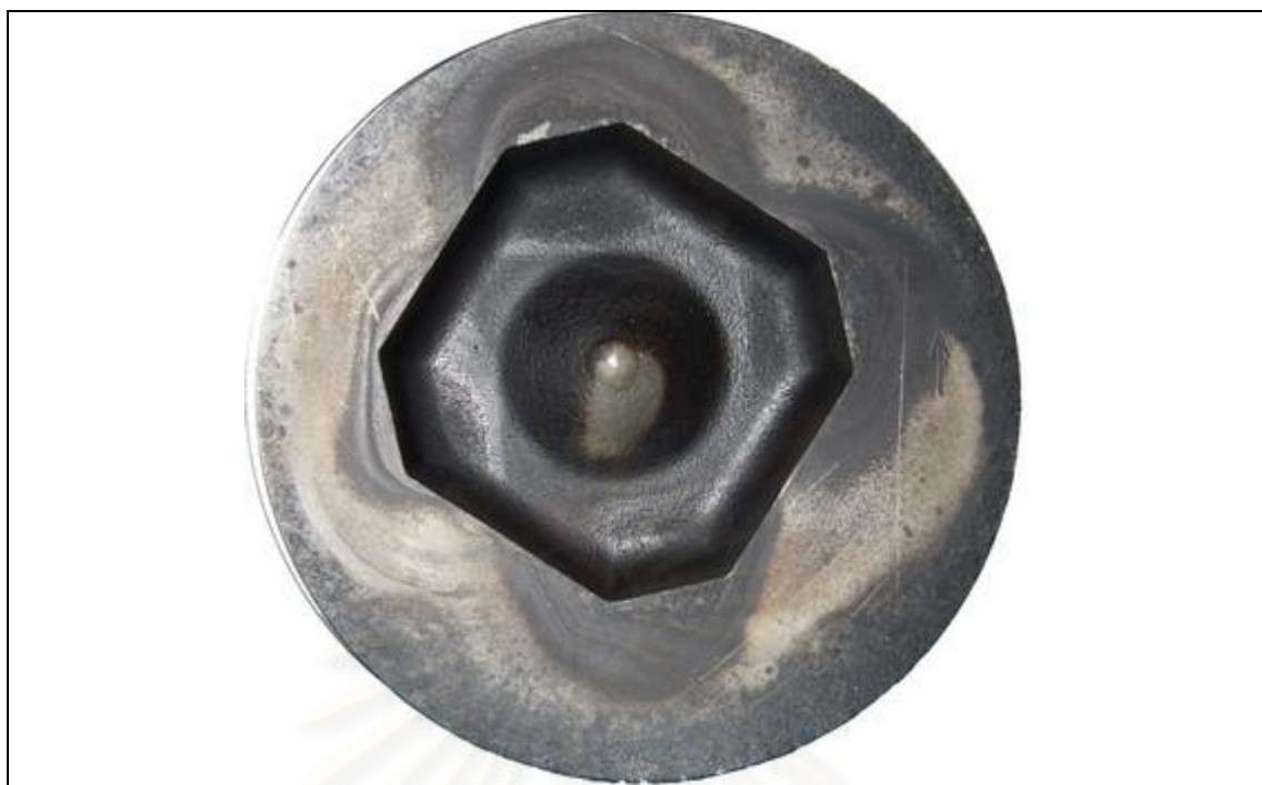
รูปที่ 5-88 ลูกสูบจากการทดสอบความทนทานเมื่อน้ำมันดีเซล
