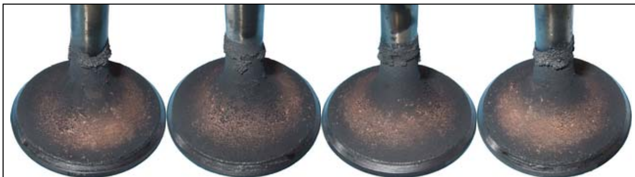
รูปที่ 5-94 แสดงภาพถ่ายวาล์วไอดีจากที่ใช้ น้ำมันดีเซล
