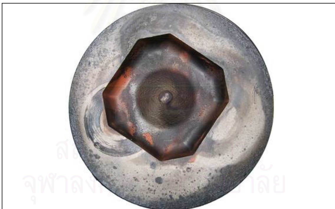
รูปที่ 5-89 ลูกสูบจากการทดสอบความทนทานเมื่อน้ำมันปาล์มไบโอดีเซล
