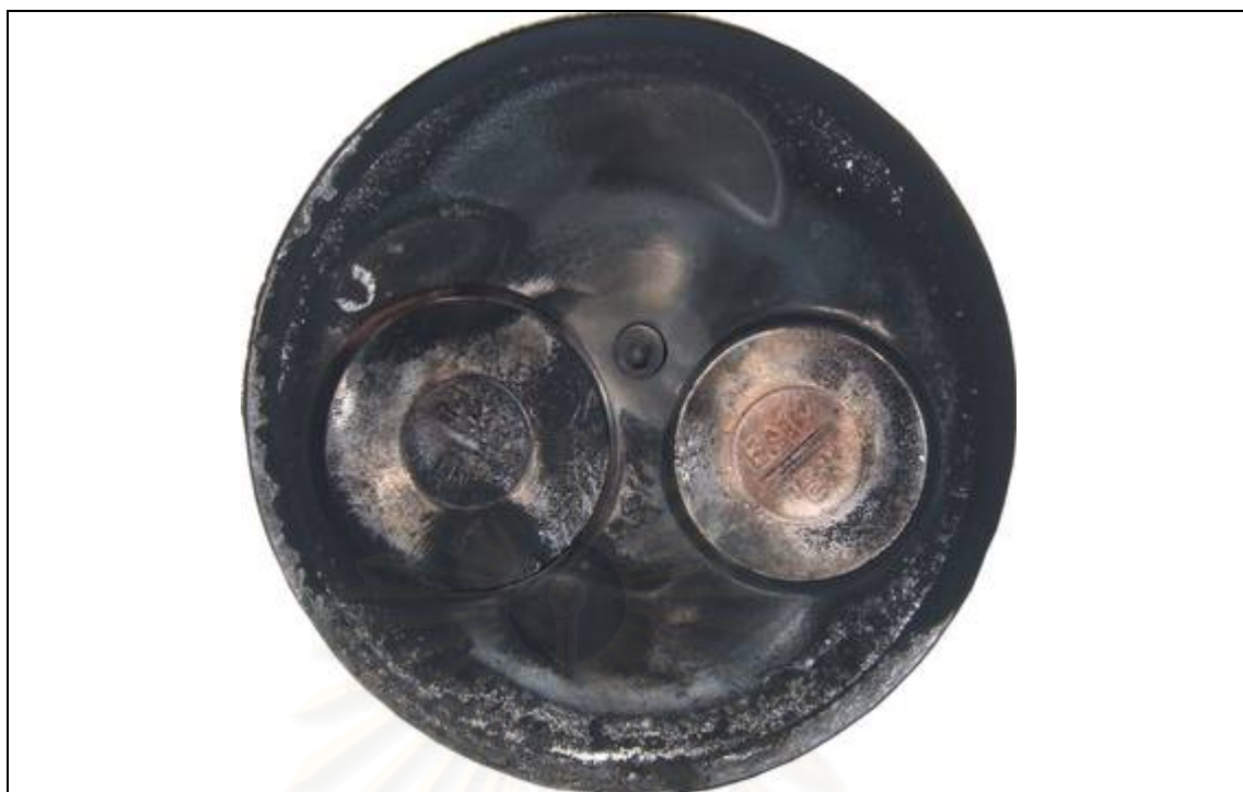
รูปที่ 5-85 แสดงภาพถ่ายฝาสอบหลังจากการทดสอบความทนทาน ของเครื่องยนต์ที่ใช้น้ำมันดีเซล
