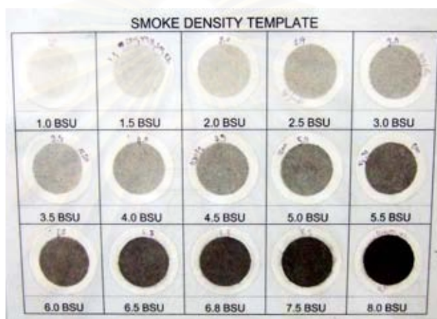
รูปที่ 4-12 แสดงตัวอย่างกระดาษกรองที่ใช้ในการวัดค่าควันดำเปรียบเทียบกับ Bosch Unit Number
