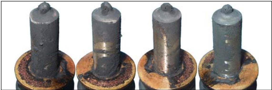
รูปที่ 5-102 แสดงภาพถ่ายหัวฉีดจากเครื่องยนต์ที่ใช้น้ำมันปาล์มไบโอดีเซล
