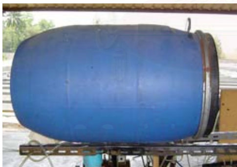
รูปที่ 4-9 แสดงถังพักอากาศและการติดตั้ง orifice plate
