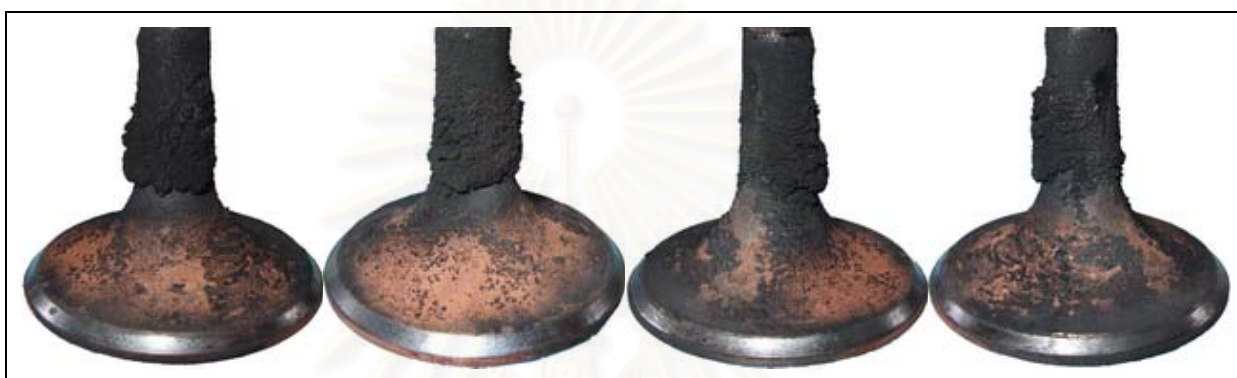
รูปที่ 5-95 แสดงภาพถ่ายวาล์วไอดีจากที่ใช้ น้ำมันปาล์มไบโอดีเซล
