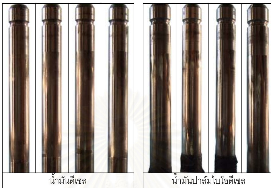
รูปที่ 5-98 แสดงภาพถ่ายของก้านวาล์วไอดีจากเครื่องยนต์ที่ใช้ น้ำมันปาล์มไบโอดีเซล
