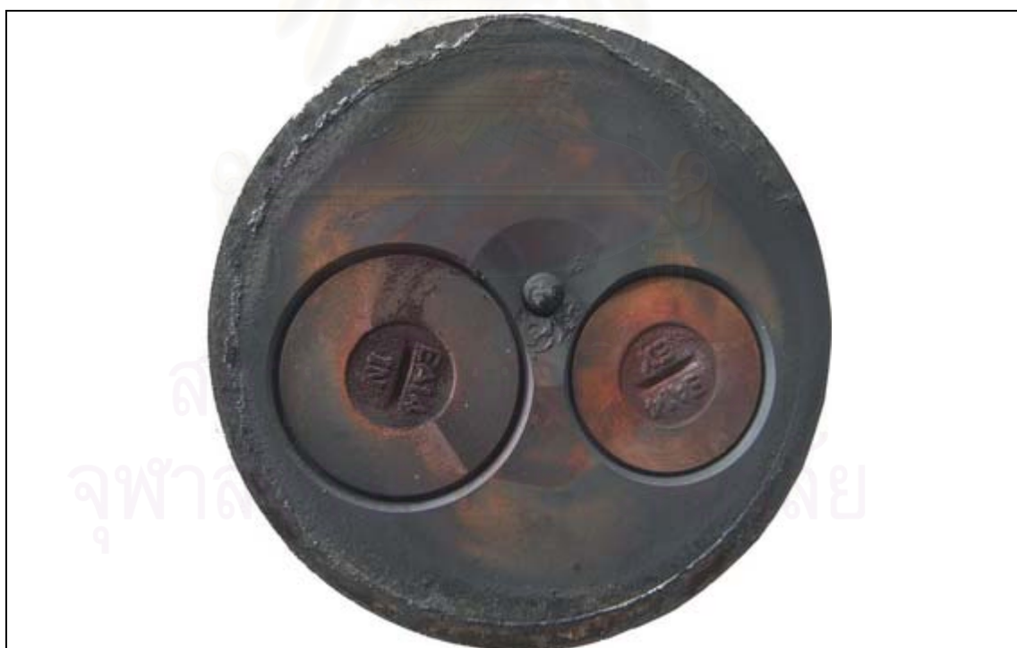
รูปที่ 5-86 แสดงภาพถ่ายฝาสอบหลังจากการทดสอบความทนทาน ของเครื่องยนต์ที่ใช้น้ำมันปาล์มไบโอดีเซล
