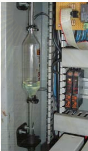
รูปที่ 4-25 แสดงอุปกรณ์วัดอัตราการสิ้นเปลืองน้ำมันเชื้อเพลิง
