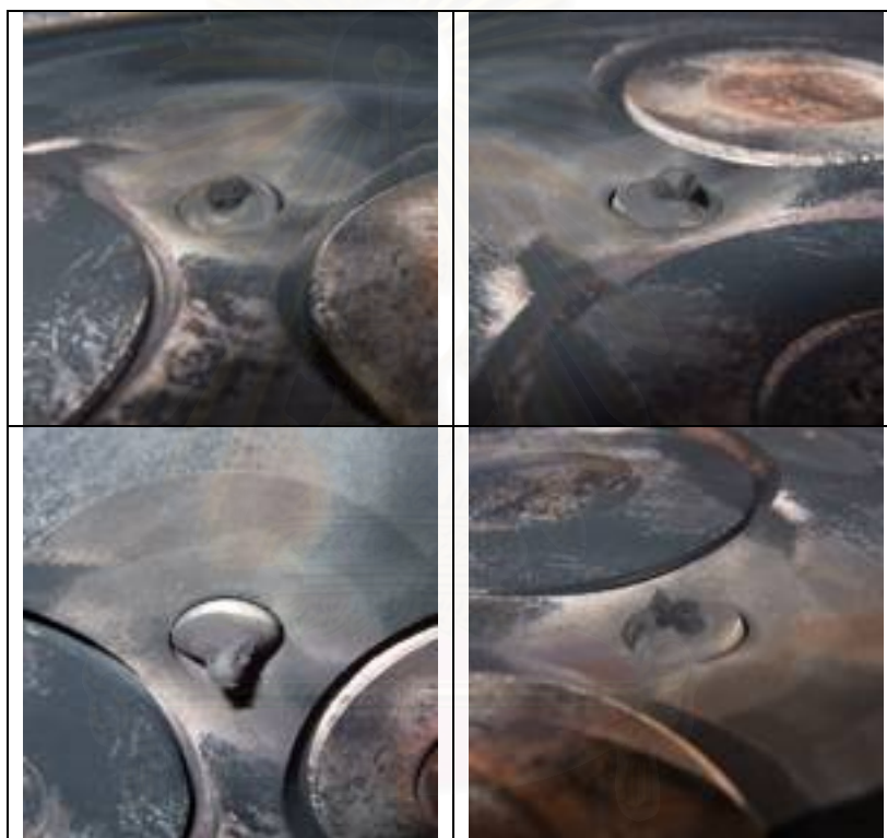
รูปที่ 5-100 แสดงภาพถ่ายหัวฉีดจากเครื่องยนต์ที่ใช้ น้ำมันดีเซล ก่อนถอดออกจากฝาสูบ
