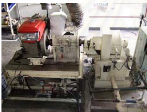
รูปที่ 4-4 แสดงชุดไดนาโมมิเตอร์ที่ใช้ในการทดสอบ (ซ้าย) แสดงไดนาโมมิเตอร์ ยี่ห้อ Tokyokoki Schenck รุ่น W - 40 (ขวา) แสดงชุดควบคุม ยี่ห้อ Tokyokoki Schenck
