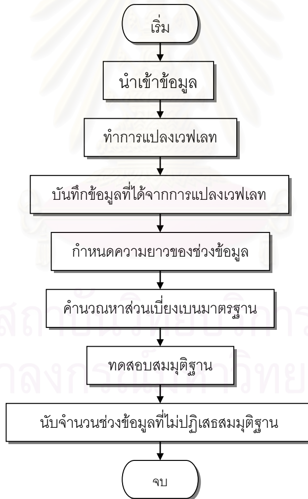
รูปที่ ข.1 แสดงขั้นตอนการทำงานของโปรแกรมที่เขียนขึ้นเองโดยใช้โปรแกรม MATLAB
