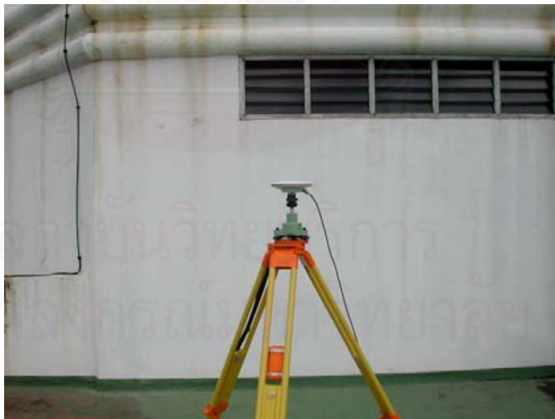
รูปที่ 3.4 แสดงการวางเสาอากาศรับสัญญาณดาวเทียมจีพีเอสที่จุด B
