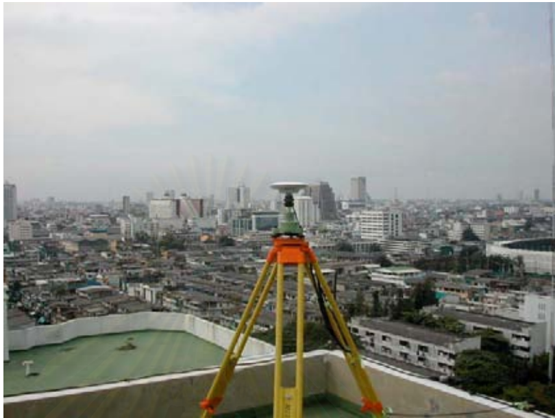
รูปที่ 3.3 แสดงการวางเสาอากาศรับสัญญาณดาวเทียมจีพีเอสที่จุด A
