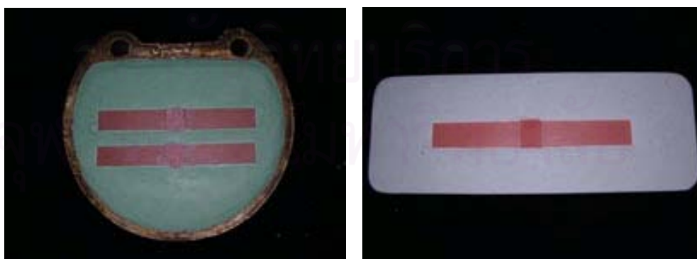
ภาพที่ 23 แสดงการใส่วัสดุที่ทำการซ่อมแซม
