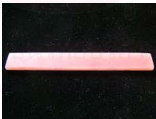
ภาพที่ 13 แสดงชิ้นงานอะคริลิกเรซินตามขนาดที่ต้องการก่อนทดสอบ
