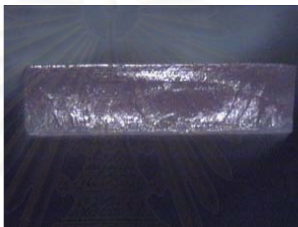
ภาพที่ 31 แสดงตัวอย่างพื้นผิวของรอยหักของอะคริลิกเรซินชนิดป่นได้เอง
