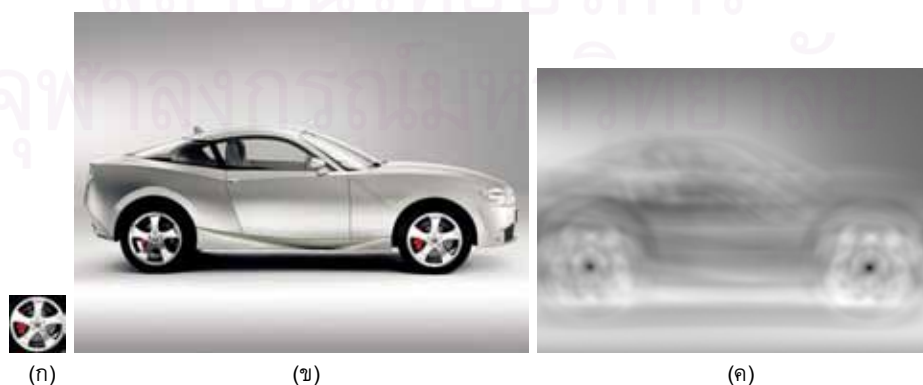
รูปที่ 5.7: วิธีการ Template matching (ก) ภาพ template (ข) ภาพต้นฉบับ (ค) ผลลัพธ์จาก Template matching
