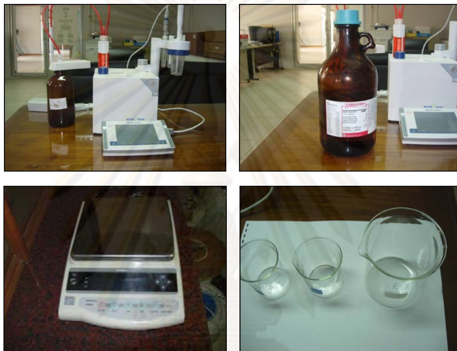
รูปที่ 5.8 เครื่องทดสอบหาปริมาณคลอไรด์จากผงคอนกรีต
