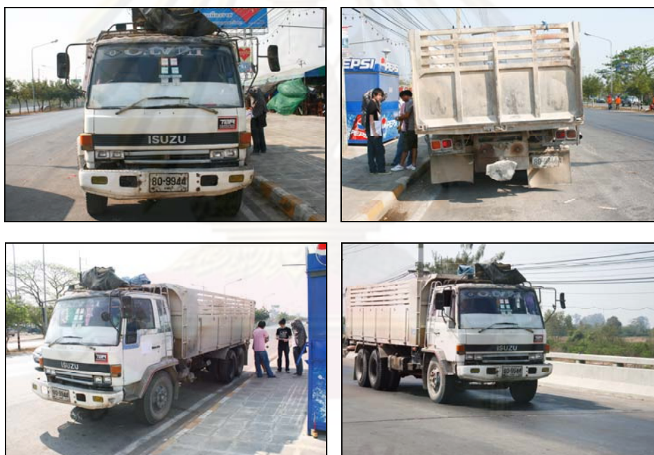
รูปที่ 3.10 รถบรรทุกที่ใช้ในการทดสอบหาน้ำหนักระบบ FAD B-WIM
