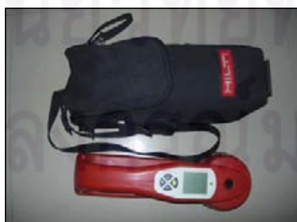
รูปที่ 5.9 การวัดระยะหุ้มเหล็กเสริม (ก) เครื่องมือวัดระยะหุ้มเหล็กเสริม
