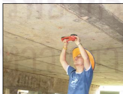
รูปที่ 5.9 การวัดระยะหุ้มเหล็กเสริม (ก) เครื่องมือวัดระยะหุ้มเหล็กเสริม
