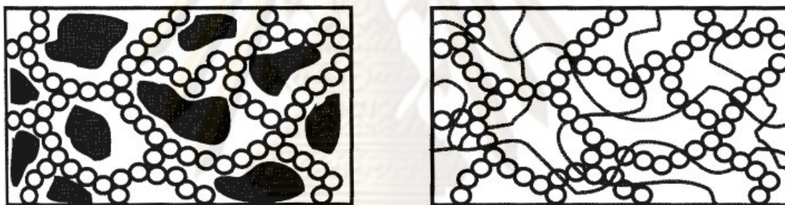
รูปที่ 2.24 โมเลกุลอินทรีย์ถูกกักอยู่ในโครงสร้างของเจล (ซ้าย) โครงสร้างพอลิเมอร์ของสารอินทรีย์และอนินทรีย์เกิดซ้อนกัน (ขวา) โดยไม่เกิดพันธะเคมีกันขึ้น (Schubert และ Husing, 2005)
