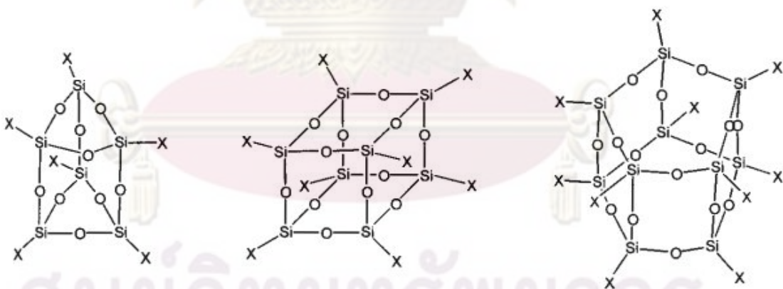
รูปที่ 2.26 โครงสร้างโมเลกุลคล้ายกรงของ (\text{XSiO}_{1.5})_n เมื่อ n = 6, 8, 10 และ X = \text{R}, \text{H}, \text{OH} (Schubert และ Husing, 2005)
