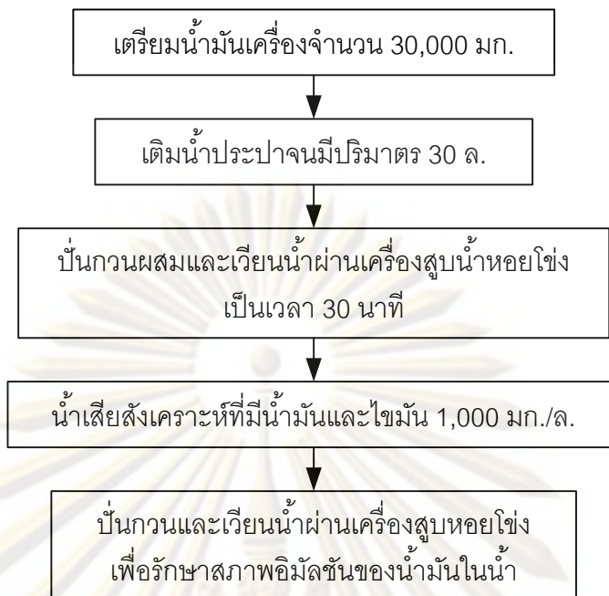
รูปที่ 3.3 การเตรียมน้ำเสียสังเคราะห์ปนเปื้อนน้ำมัน ความเข้มข้นของน้ำมัน 1,000 มิลลิกรัมต่อลิตร ปริมาตร 30 ลิตร
