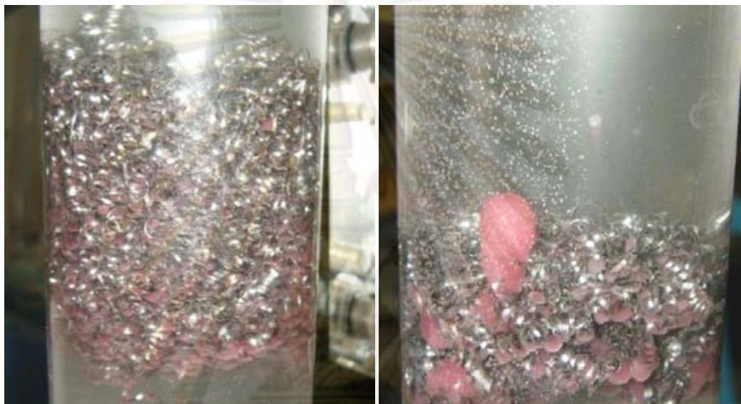
รูปที่ 4.18 อนุภาคน้ำมันบางส่วนติดอยู่บนชั้นตัวกลาง (ซ้าย) และอนุภาคน้ำมันที่รวมตัวกันจนมีขนาดใหญ่หลุดออกจากชั้นตัวกลาง (ขวา)
