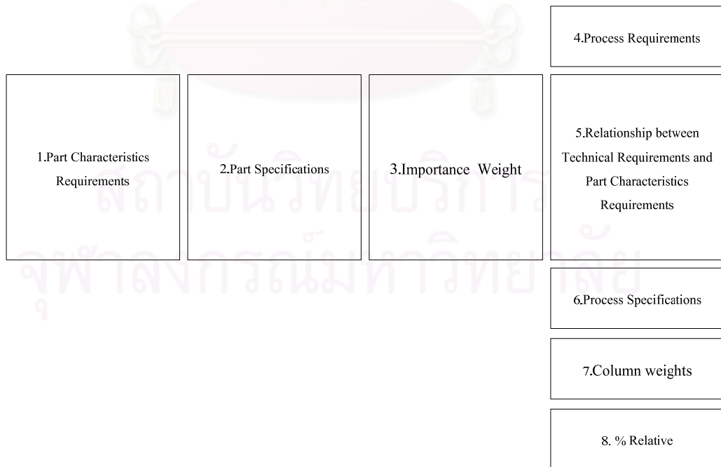
รูปที่ 6.1 ส่วนประกอบของการวางแผนกระบวนการผลิตของเมตริกที่ 3
