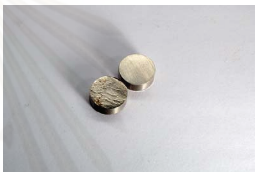
ข. ผิวของชิ้นงานก่อนและหลังขัด
