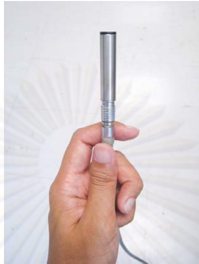
รูปที่ ค.2 ลักษณะของไมโครโฟนสำหรับวัดสัญญาณของชิ้นงาน
