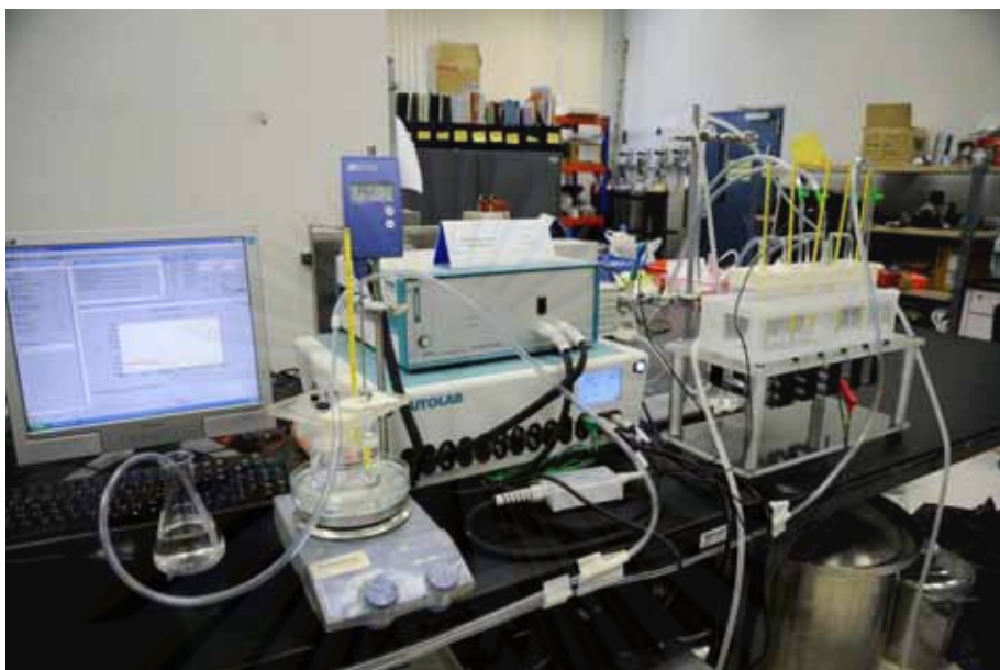
รูปที่ 3.18 ลักษณะการต่อวงจรสำหรับทดสอบการกัดกร่อน
