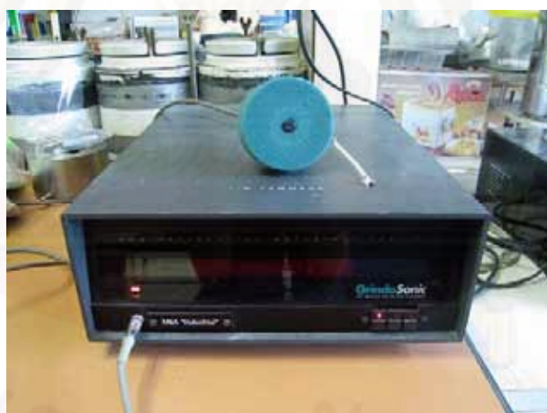
รูปที่ 3.6 ลักษณะของเครื่อง Grindosonic ฟองน้ำสำหรับวางชิ้นงานและที่เคาะสัญญาณ
