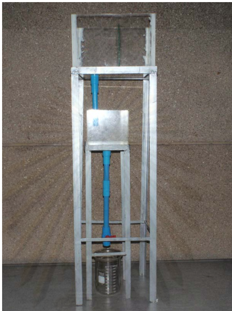
รูปที่ 3.8 อุปกรณ์จริงที่ใช้ในการวัดอัตราการไหลของของเหลวผ่านโฟมเงิน
