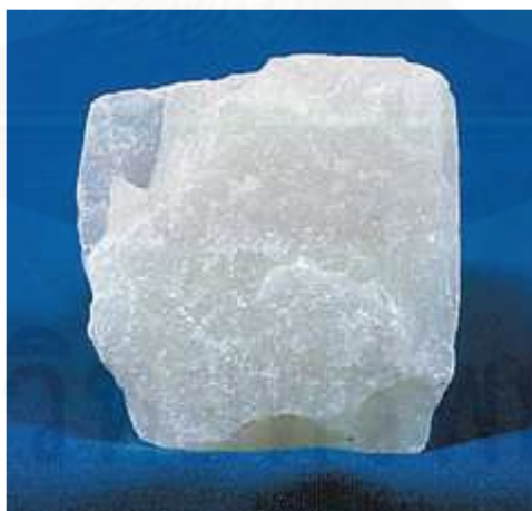
รูปที่ 2.5 ทัลก์ หรือ ไฮดรรัสแมกนีเซียมซิลิเกต (Hydrous magnesium silicate : Mg_3 Si_4O_{10}(OH)_2 ) (ที่มา : wikipedia.org/wiki/Talc)
