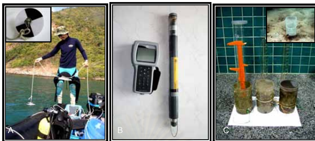
รูปที่ 3.3 การเก็บข้อมูลปัจจัยทางกายภาพของน้ำและอุปกรณ์ที่ใช้ A: แผ่น secchi disk; B: เครื่องวัดคุณภาพน้ำ YSI-multiprobe และ C: ขวดดักตะกอน
