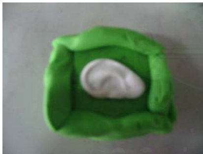
รูปที่ ค1 แม่แบบก่อนทำการหล่อด้วย ซิลิโคน
