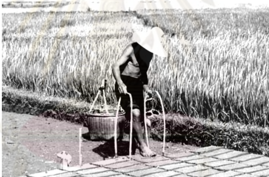
ภาพที่ 2-34 แสดงการทำอิฐสำหรับก่อผนังโดยการตากแสงอาทิตย์ (Sundried Brick) (Knapp, 2005)
