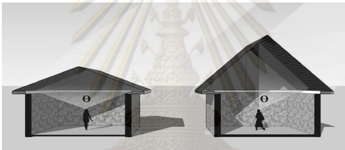
ภาพที่ 4-17 แสดงมุมกระทำของหลังคาต่อร่างกายที่ต่างกัน ระหว่างมุมหลังคาที่แบน (ช้ำ) และมุมหลังคาที่มีความชันมากกว่า (ชว) ซึ่งทำให้อุณหภูมิผิวภายในหลังคามีผลต่อร่างกายมนุษย์แตกต่างกันเนื่องจากมุมกระทำต่างกัน
