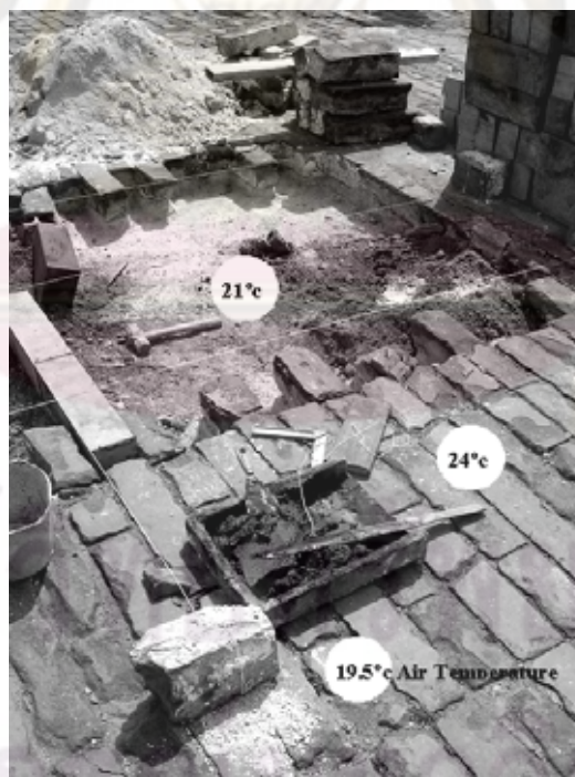
ภาพที่ 4-32 แสดงอุณหภูมิผิววัสดุลานกลางอาคาร เปรียบเทียบกับอุณหภูมิอากาศ และอุณหภูมิของดิน วันที่ 13 กันยายน 2551 เวลา 10:25 น.
