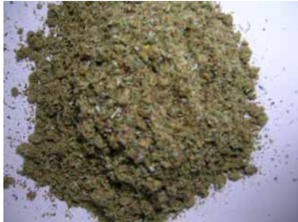
รูปที่ 4.2 ลักษณะมูลฝอยที่ผ่านการบดแล้วนำมาผสมกันตามสัดส่วนองค์ประกอบทางกายภาพของมูลฝอย
