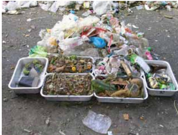
รูปที่ 4.1 ลักษณะการคัดแยกมูลฝอยออกเป็นประเภท
