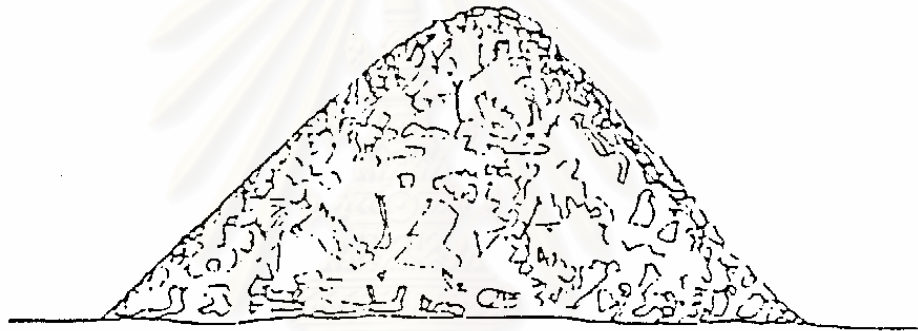
รูปที่ 3.3 ลักษณะการกองมูลฝอยให้เป็นรูปกรวยก่อนที่แบ่งมูลฝอยออกเป็น 4 ส่วน (ไพศาล ผดุงศิริกุล, 2536)
