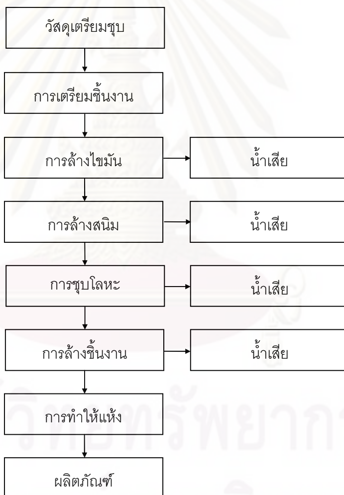
รูปที่ 2.2 ขั้นตอนการชุบโลหะด้วยไฟฟ้า
