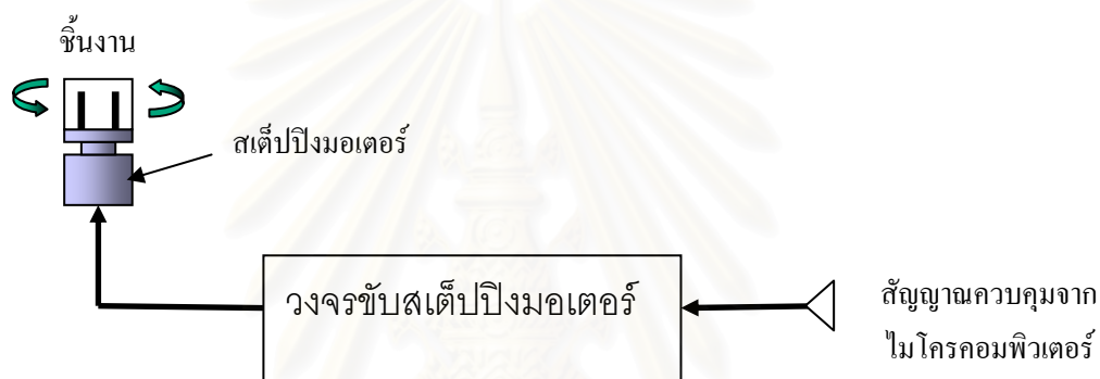
รูปที่ 3.3 แผนภาพระบบหมุนวัตถุตัวอย่าง [2]
