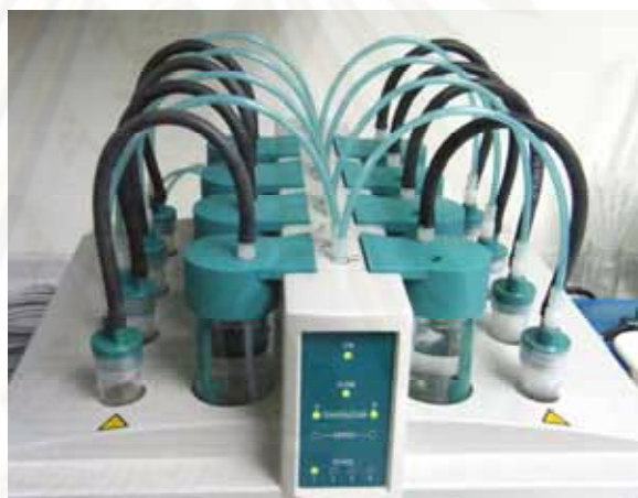
รูปที่ ก.4 เครื่อง Rancimat® (Metrohm, รุ่น 743 Rancimat®, Switzerland)
