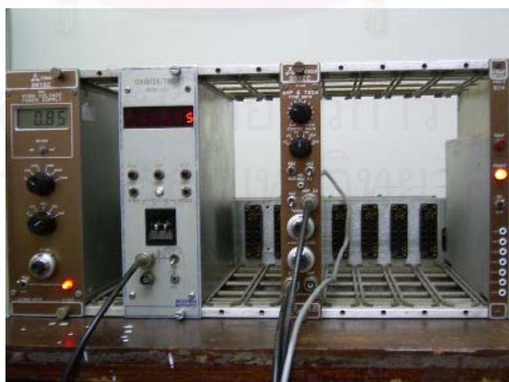
รูปที่ 3.10 แสดงภาพถ่ายของระบบวัดรังสีเฉพาะพลังงาน
