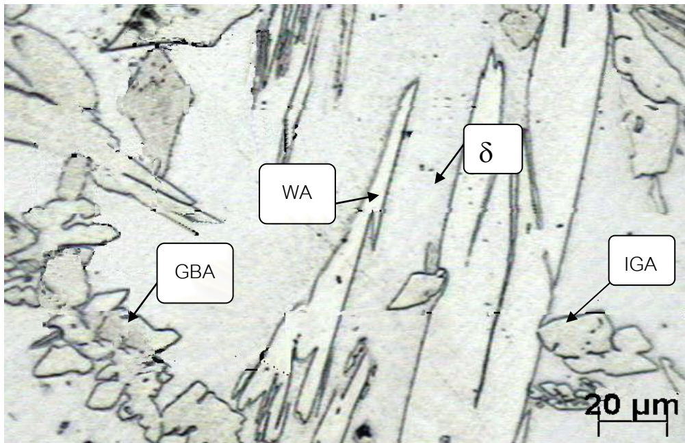
รูปที่ 4.23 โครงสร้างจุลภาคของเหล็ก K3 ที่ผ่านการจำลองเชื่อม
