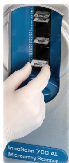
รูปที่ 2.4 (ซ้าย) เครื่อง InnoScan 700 AL (ที่มา: http://www.innopsys.fr ) (ขวา) ผลลัพธ์ที่ได้จากการสแกนด้วยเครื่องสแกนไมโครอาร์เรย์
