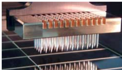
รูปที่ 2.3 เครื่อง Stealth Printhead (SPH48) พร้อมด้วยหัวพิมพ์ 48 หัว (ที่มา: http://www.euro-bio-net.com )
