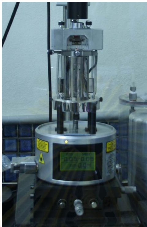
รูปที่ 7 แสดงกล้องจุลทรรศน์แบบแรงอะตอม รุ่นนาโนสโคปรุ่นที่สี่
