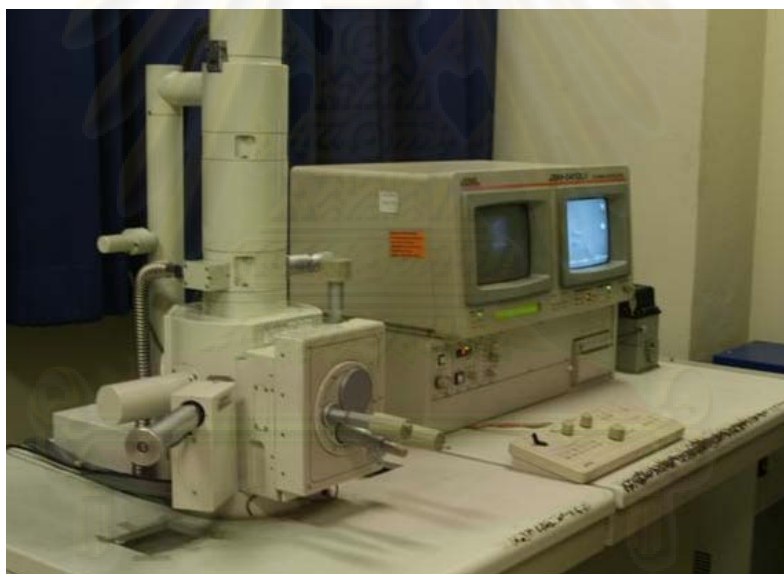
รูปที่ 8 แสดงกล้องจุลทรรศน์อิเล็กตรอนชนิดส่องกราด (Scanning Electron Microscope; JEOL JSM-5410 LV Scanning Microscope)
