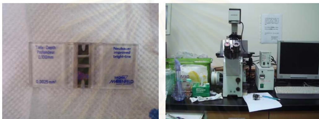
รูปที่ 3.2 ก) แสดงภาพของ counting chamber และ ข) แสดงภาพกล้องจุลทรรศน์แบบหัวกลับ
