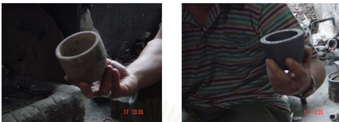
รูปที่ 3.3 เบ้าหลอมโดยรูปทางซ้ายเป็นเบ้าเมืองรูปทางขวาเป็นเบ้าใต้
