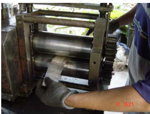
รูปที่ 3.15 เป็นการขึ้นรูปเงินที่เรียกว่าการชักลวด โดยรูปซ้ายเป็นการรีดเงินให้มีลักษณะแบน ส่วนรูปขวาเป็นการดึงเงินให้มีลักษณะกลม
