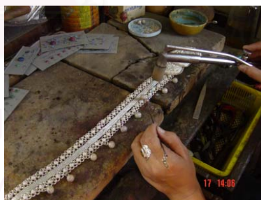
รูปที่ 3.20 ภาพซ้ายเป็นการติดลูกกระพวนกับเข็มขัดโดยการทาด้วยน้ำประสาน หลังจากนั้นในภาพขวาใช้ความร้อนเป่าเพื่อให้ลูกกระพวนติดกับเข็มขัด
