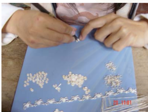
รูปที่ 3.19 ภาพซ้ายเป็นการนำเงินที่มีลักษณะเหมือนเส้นลวดมาขดเป็นวงกลมเพื่อใส่ลงไปในโครงสร้างรูปผีเสื้อและดอกไม้ที่ได้ทำไว้ก่อนแล้ว ซึ่งจะได้ในภาพขวา
