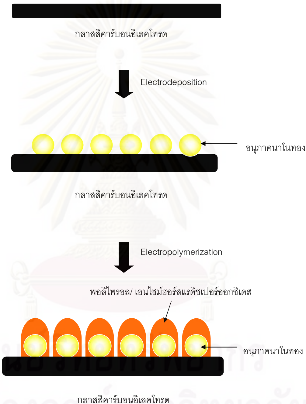
รูปที่ 1.1 การสังเคราะห์อนุภาคนาโนทอง/ พอลิไพร์รอล สำหรับฟีนอลไปโอเซนเซอร์
