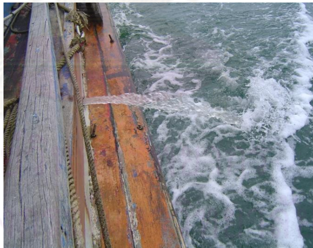
รูปที่ 3.8 การปล่อยน้ำอับเฉาเรือของเรือประมง
