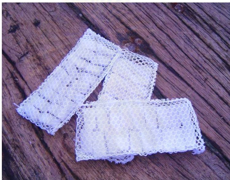
รูปที่ 3.9 เซลล์ยีสต์ที่ตรึงอยู่บนโพงพอลิยูรีเทนที่บรรจุอยู่ในตาข่าย
