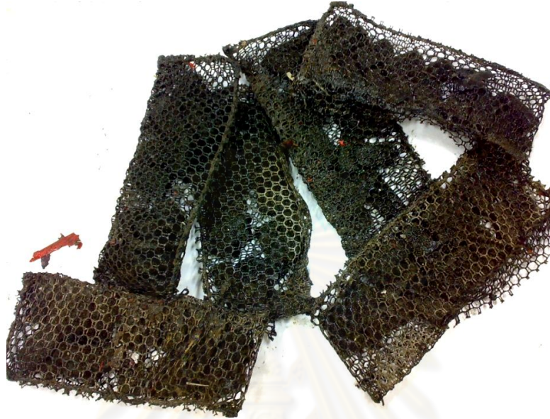
รูปที่ 4.14 ลักษณะของโฟมพอลิเอทรีเทนที่ผ่านการบำบัดน้ำมันที่ปนเปื้อนในน้ำอับเฉาเรือซึ่งเก็บขึ้นมาจากห้องอับเฉาเรือบริเวณใต้ท้องเรือประมงขนาดเล็กสำหรับวิเคราะห์ปริมาณน้ำมัน
