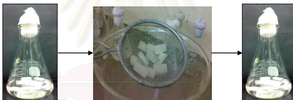
รูปที่ 3.5 ส่วนที่ 2 โดยประกอบด้วยเซลล์ตรึงและอาหารเลี้ยงเชื้อเหลว NSW ที่มีน้ำมันเครื่องความเข้มข้น 200 ppm ที่ผ่านการใช้งานมาแล้ว จากนั้นกรองเซลล์ตรึงใส่ลงไปในพลาสติกใหม่ที่มีความเข้มข้นของน้ำมันเท่ากับการทดลองเริ่มต้นสำหรับการกรองเซลล์ตรึงนำกลับไปใช้ซ้ำ
