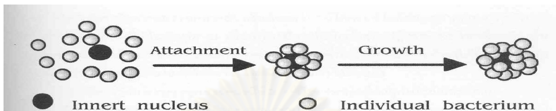
รูปที่ 2.7 การเกิดตะกอนเม็ดแบบ inert nuclei model (Yu และคณะ, 2003)
