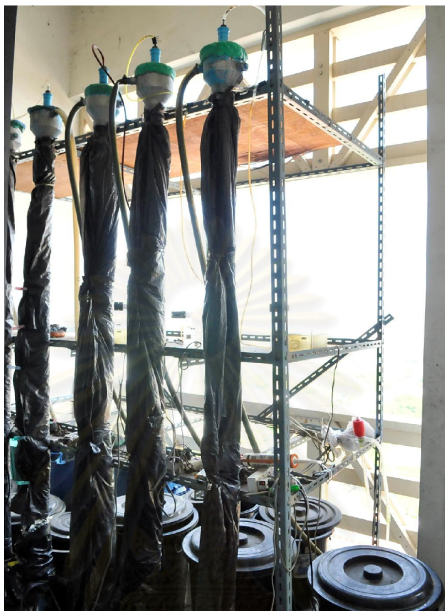
รูปที่ 3.2 ลักษณะการติดตั้งระบบยูเอเอสบี
