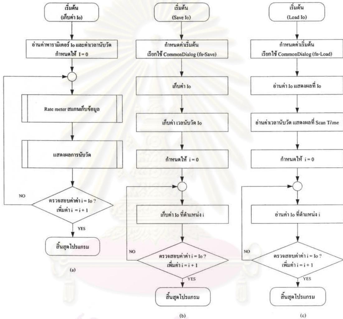
รูปที่ 3.16 แผนภาพการเก็บ บันทึก และเรียกใช้ ค่านับวัด I_0
