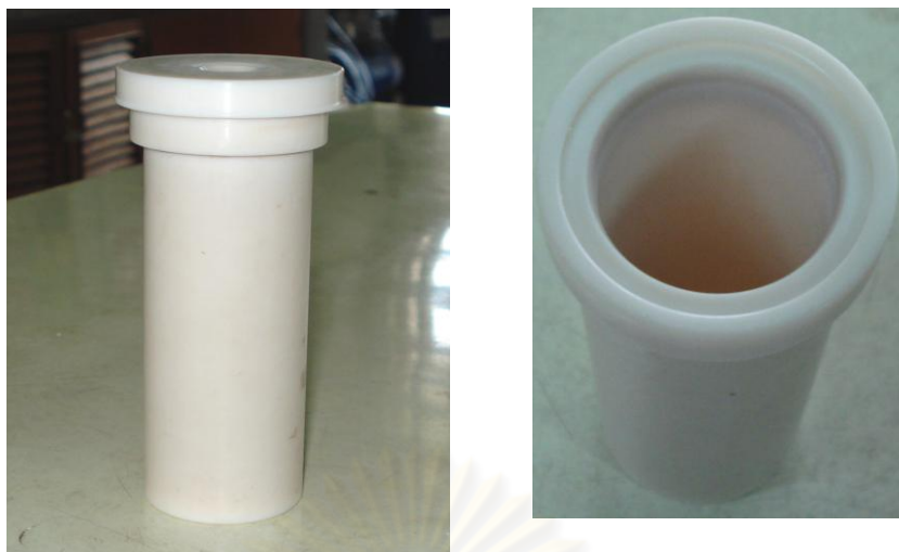
รูปที่ 3.2 เทฟรอนภายในเครื่องปฏิกรณ์
