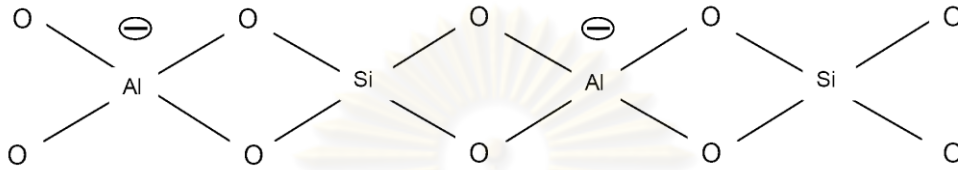
รูปที่ 2.20 ประจุลบที่เกิดจากการแทนที่ด้วย (\text{AlO}_2)^- ในโครงสร้างของซีโอไลต์ (เลิศ รักสันติชาติ, 2545)
