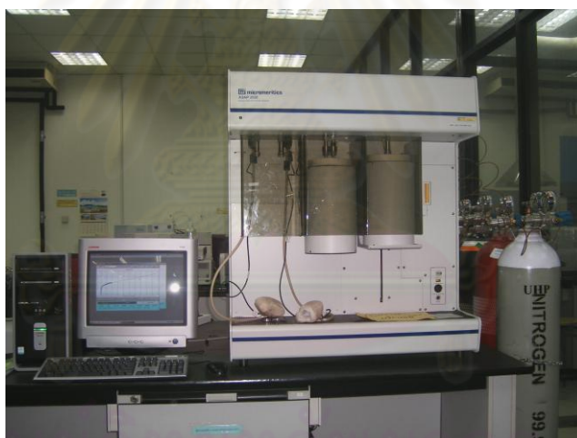
รูปที่ 3.8 เครื่องตรวจสอบพื้นที่ผิวจำเพาะ
