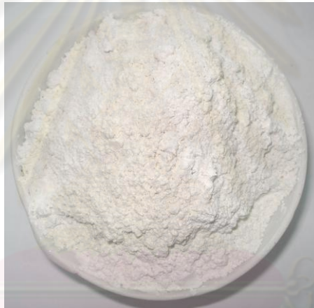
รูปที่ 4.1 ดินขาวธรรมชาติที่ใช้เป็นวัตถุดิบในการสังเคราะห์ซีโอไลต์ MCM-22
