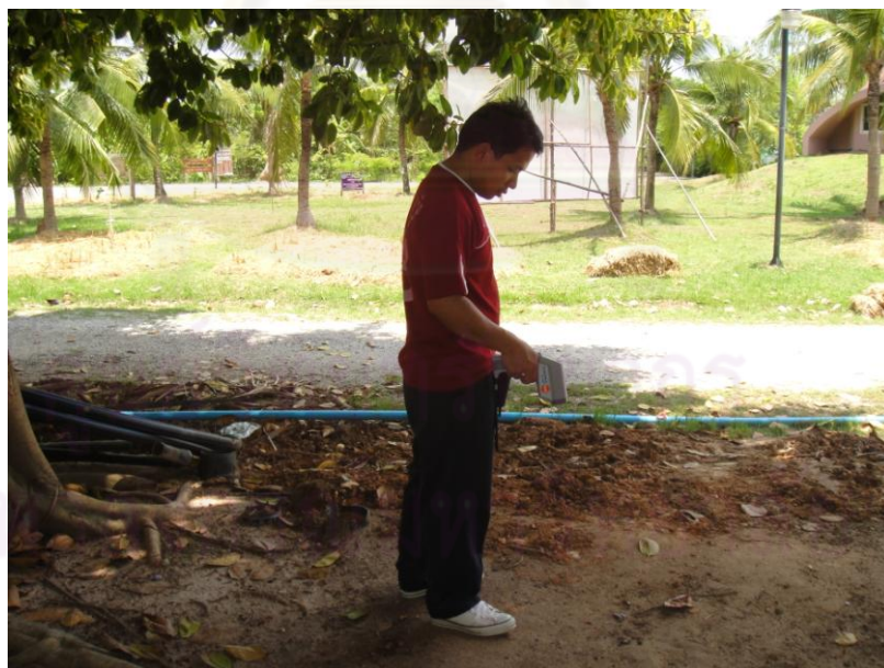
ภาพที่ 4 - 4 การบันทึกข้อมูลผิวดินในที่ร่ม เวลา 14.00 น. วันที่ 7 พฤษภาคม 2553 อุณหภูมิผิวดินในที่ร่มไม้โดนแดด 34.4^{\circ}\text{C}
