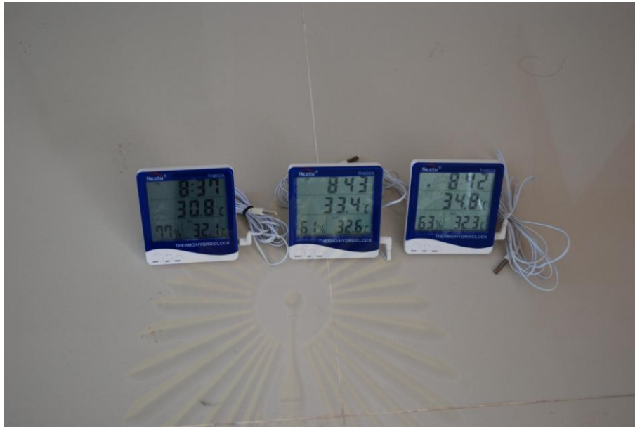
ภาพที่ 3-4 เครื่องมือวัดอุณหภูมิอากาศ อุณหภูมิกระเปาะเปียกและความชื้นสัมพัทธ์
