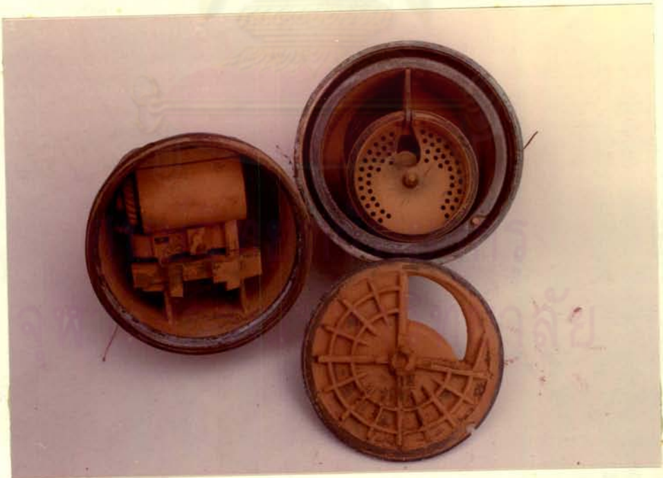
สภาพระบบการทำงานภายในของมาตรฐานลูกสูบ อายุการใช้งาน 6 ปี
