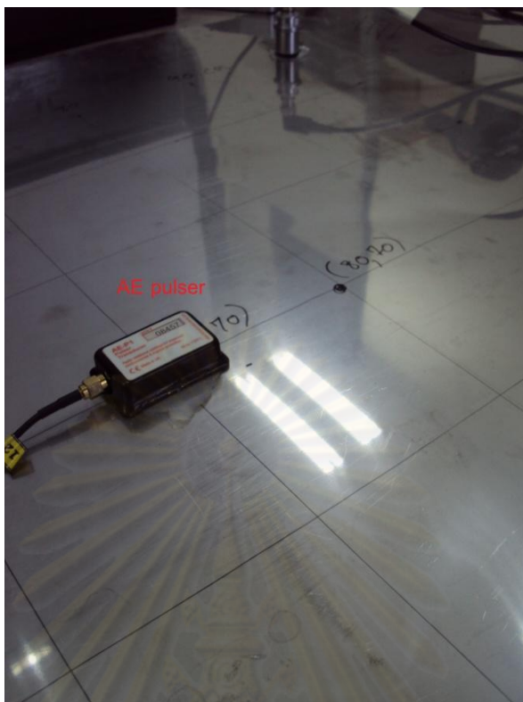
รูปที่ 5.10 การติดตั้งตัวกำเนิดสัญญาณอคูสติก
