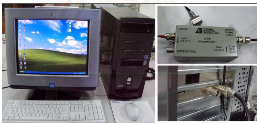
รูปที่ 5.3 ชุดทดสอบวัดสัญญาณอคูสติก, เครื่องคอมพิวเตอร์ที่ติดตั้งการรับสัญญาณ (ภาพซ้าย), หัววัดและอุปกรณ์ขยายสัญญาณ (ขวาบน), และช่องรับสัญญาณของการติดตั้งด้านท้ายเครื่องคอมพิวเตอร์ (ขวาล่าง)
