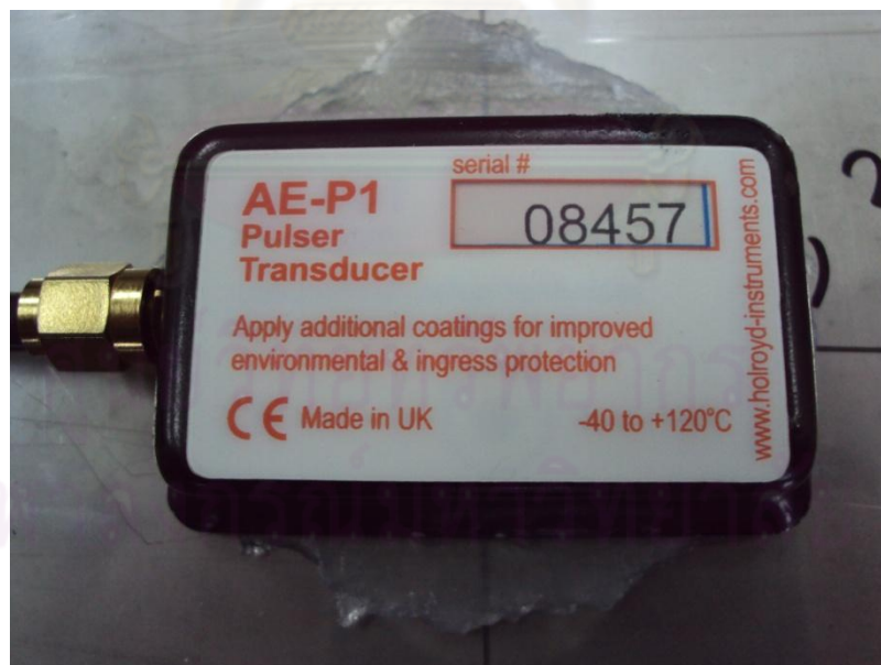
รูปที่ 5.11 ตัวกำเนิดสัญญาณอคูสติก (AE Pulser)
