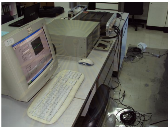
รูปที่ 5.8 ระบบการประมวลผลสัญญาณการปล่อยคลื่นอคูสติกเพื่อหาตำแหน่ง
