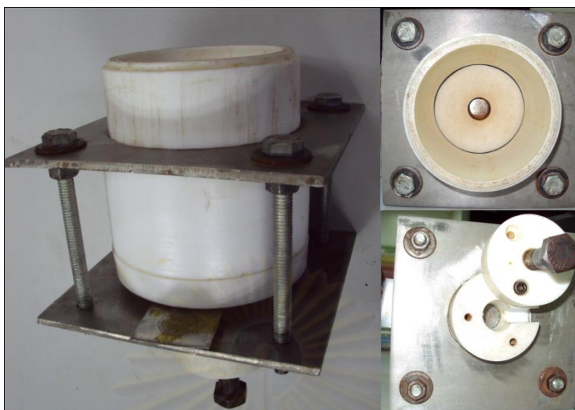
รูปที่ 5.2 แสดงกระบอกบรรจุสารเคมีสำหรับทดสอบการกักความร้อน
