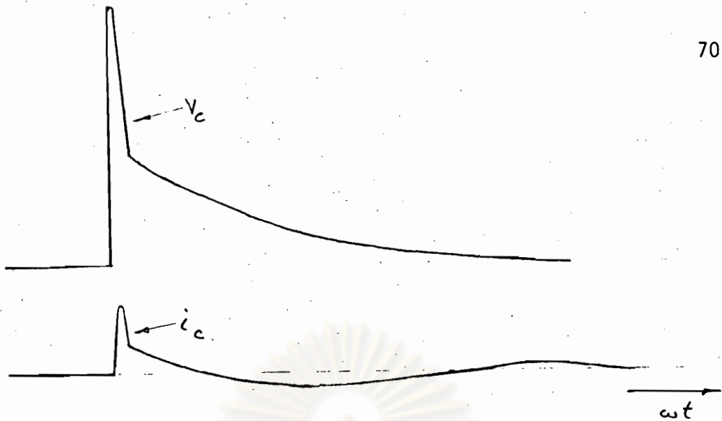
รูปที่ 7.1 แสดงรูปคลื่นแรงดันไฟฟ้าคร่อมตัวเก็บประจุ C และรูปคลื่นกระแสคอมมิวเตต i_c จาก Clamp meter
