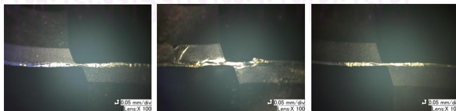
รูปที่ 4.34 ลักษณะการสึกหรอของมีดกัดด้วยเงื่อนไขการตัดแบบต่างๆ ก) การตัดแบบเปียก ข) การตัดแบบแห้ง และ ค) การใช้สเปร์ยสารหล่อเย็น
