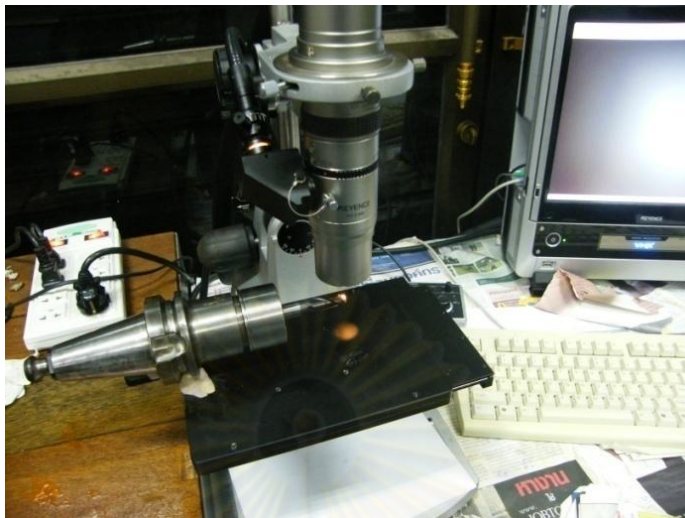
รูปที่ 3.17 การวัดขนาดความสึกหรอของมีดกัด
