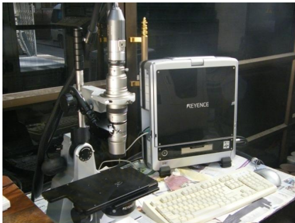
รูปที่ 3.8 ไมโครสโคปสำหรับวัดขนาดความลึกหรือ
