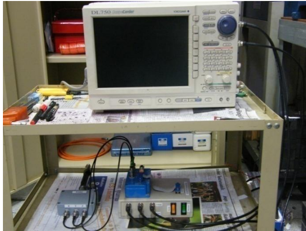
รูปที่ 3.15 การเชื่อมต่อสายไดนาโมวัตต์แรงเข้ากับเครื่องขยายสัญญาณและเครื่องออสซิลโลสโคป
