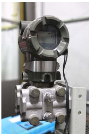
รูปที่ 3.11 อุปกรณ์วัดความดัน Differential Pressure Transmitter (DPT)
