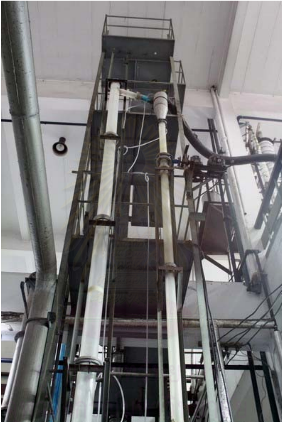
รูปที่ 3.7 เครื่องจำลองฟลูอิด์เบดแบบหมุนเวียน
