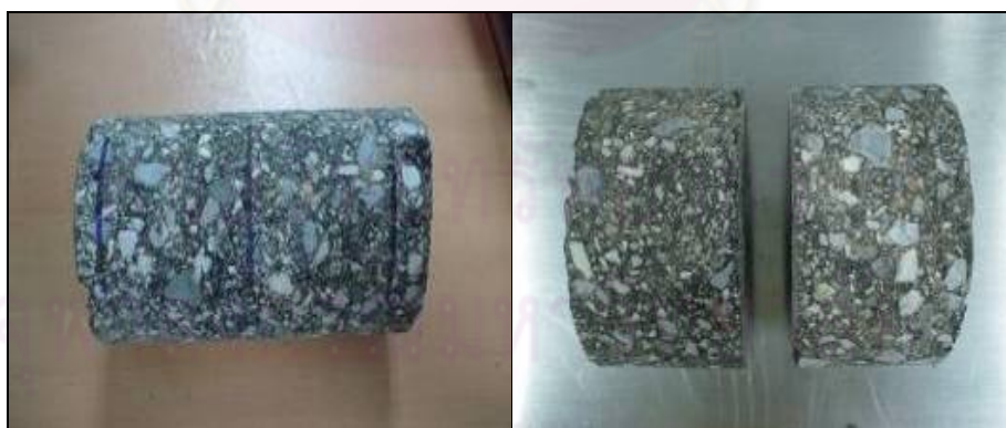
ภาพที่ 5.7 ก้อนตัวอย่างที่เจาะเก็บในสนามที่ตัดออกเป็นสองส่วน
