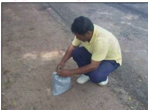
ภาพที่ 3.4 การเก็บตัวอย่างวัสดุที่ได้รับการปรับปรุงคุณภาพด้วยโพลีเมอร์แล้ว
