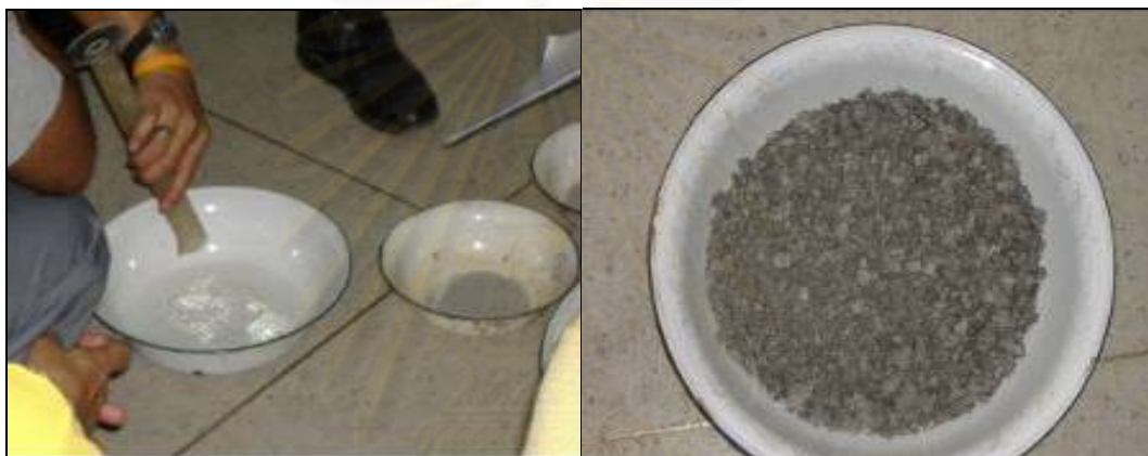
ภาพที่ 3.13 การเตรียมส่วนผสมตามสัดส่วนที่ออกแบบไว้
