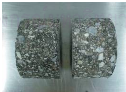
ภาพที่ 3.11 ก้อนตัวอย่างที่ตัดเรียบร้อยแล้ว
