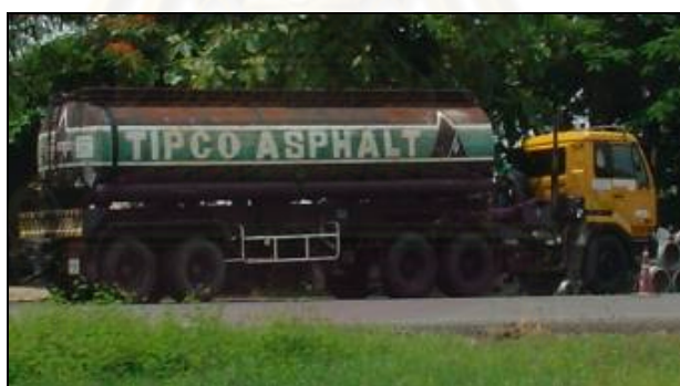
ภาพที่ 4.5 รถบรรทุกยางแอสฟัลต์เกรด 60-70 เพื่อใช้ในการผลิตโฟมแอสฟัลต์
