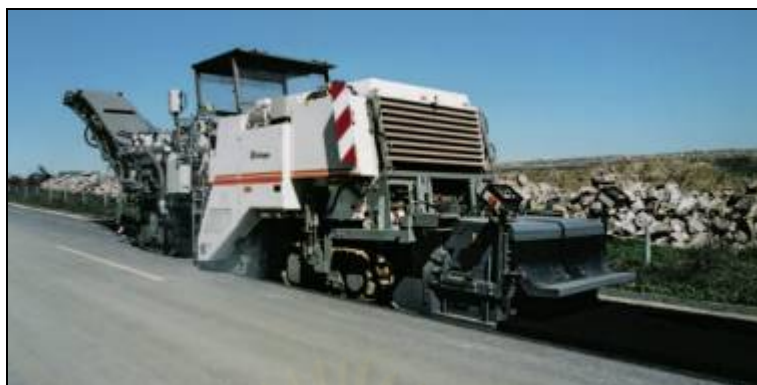
ภาพที่ 2.2 การปรับปรุงคุณภาพแบบผสมในที่ (In-Place Recycling)
