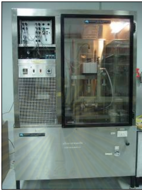
ภาพที่ 3.20 เครื่องมือทดสอบค่าโมดูลัสคืนตัว
