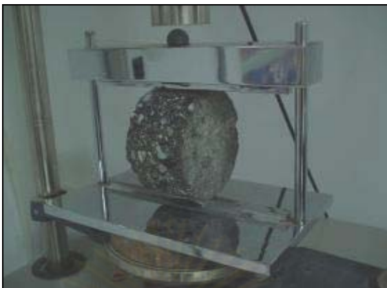
ภาพที่ 3.19 การจัดวางก้อนตัวอย่างในการทดสอบหาค่าความต้านทานต่อแรงดึงทางอ้อม
