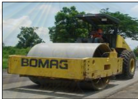
ภาพที่ 4.8 รถบดสันตะเทือนล้อเหล็ก (Smooth Drum Roller)
