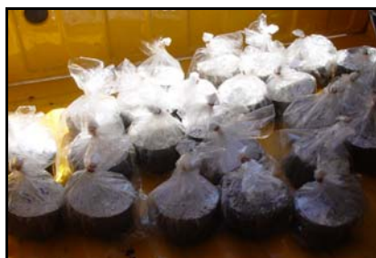
ภาพที่ 5.9 ส่วนผสมโฟมแอสฟัลต์ที่ผสมในสนามและบดอัดในห้องปฏิบัติการ
