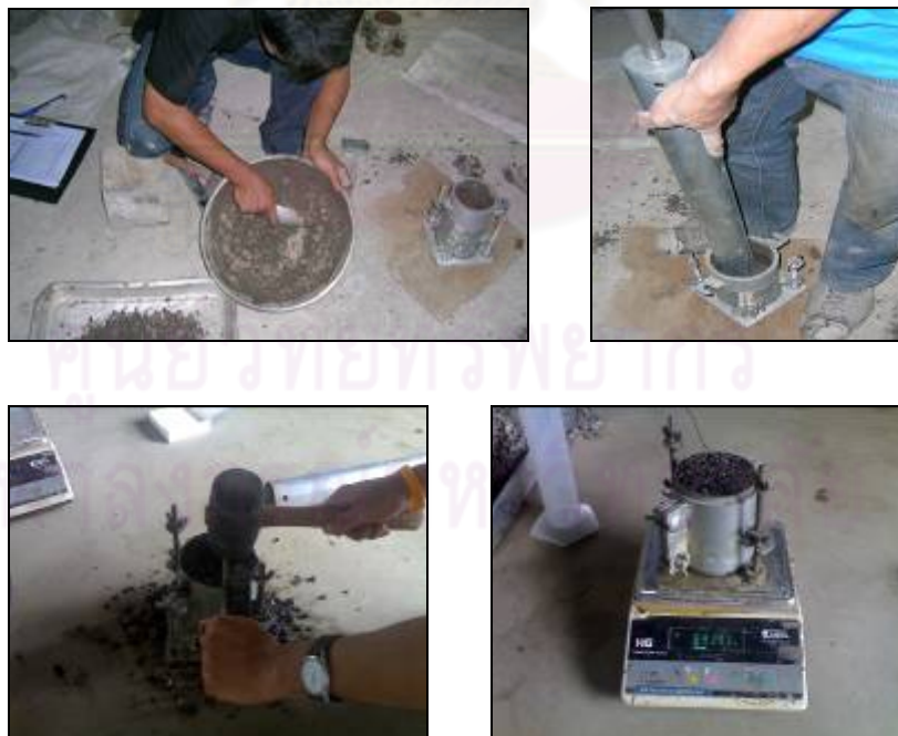
ภาพที่ 3.8 การทดสอบหาปริมาณความชื้นที่เหมาะสมสำหรับการบดอัด
