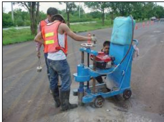
ภาพที่ 3.1 การเจาะเก็บก้อนตัวอย่างในสนาม
