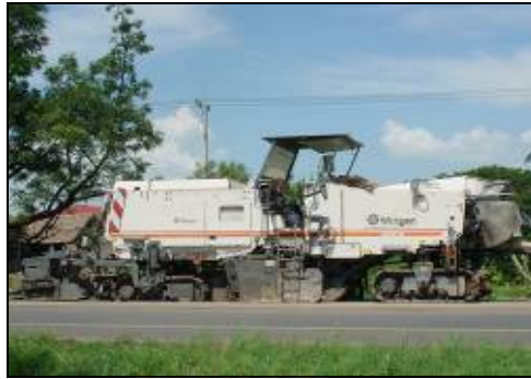
ภาพที่ 4.7 เครื่องกัดและผสมในตัว (Recycler)
