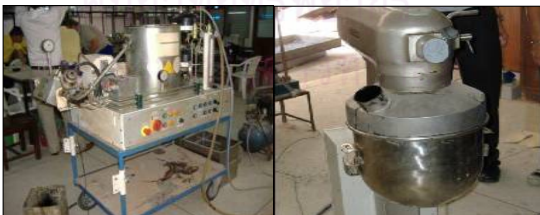
ภาพที่ 3.14 เครื่องฉีดโฟมแอสฟัลต์และเครื่องผสมในห้องปฏิบัติการ
