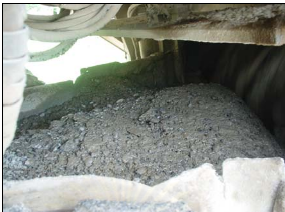
ภาพที่ 4.12 บริเวณห้องผสม (Mixing Chamber) ของเครื่องกัดและผสม
