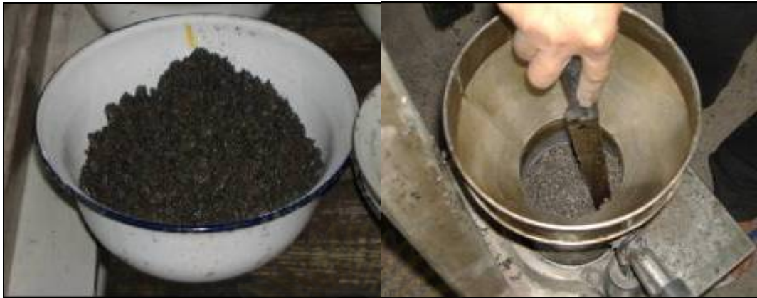
ภาพที่ 3.15 การนำส่วนผสมที่ได้ไปใส่ใน Mold ที่เตรียมไว้
