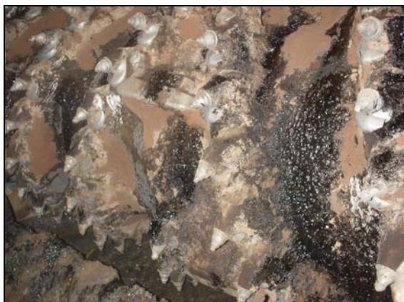
ภาพที่ 4.17 หัวกัดของเครื่องกัดและผสมที่ใช้ในการชูดไสวัสดุโครงสร้างทางเดิม
