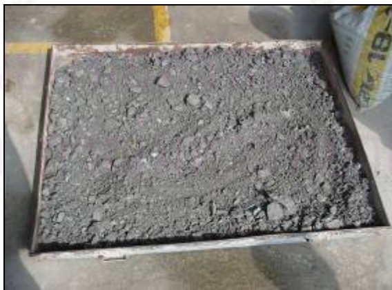
ภาพที่ 3.6 วัสดุโครงสร้างทางเดิม (Reclaimed Asphalt Pavement: RAP)
