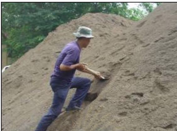
ภาพที่ 3.7 การเก็บตัวอย่างวัสดุมวลรวมใหม่ (หินฝุ่น) จากกองวัสดุหน้างาน
