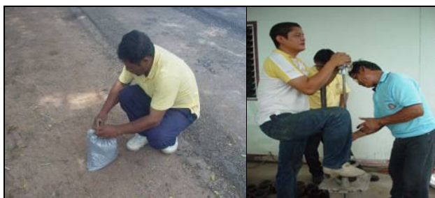
ภาพที่ 5.8 การนำส่วนผสมโพนแอสฟัลต์ในสนามมาบดอัดโดยวิธีมาร์แชล
