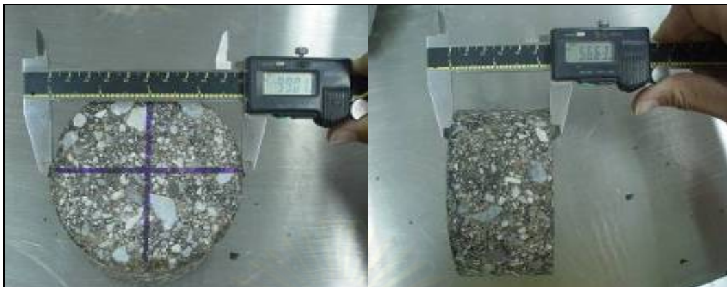
ภาพที่ 3.12 การวัดขนาดของก้อนตัวอย่าง
