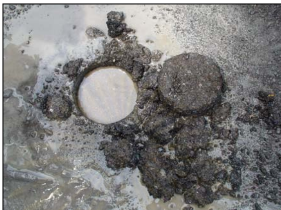
ภาพที่ 5.6 ลักษณะก้อนตัวอย่างที่มีอายุน้อยกว่า 7 วัน ที่เจาะเก็บในสนาม
