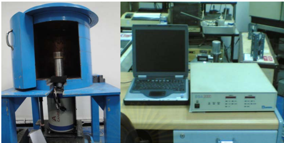
รูปที่ 3.15 ระบบวัดรังสีแกมมาของ Canberra
