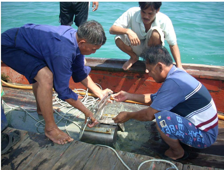
รูปที่ 3.3 การเก็บตัวอย่างตะกอนดิน
