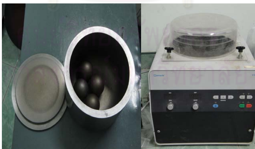
รูปที่ 3.4 เครื่องบดสารตัวอย่างพร้อมโถบดตัวอย่าง
