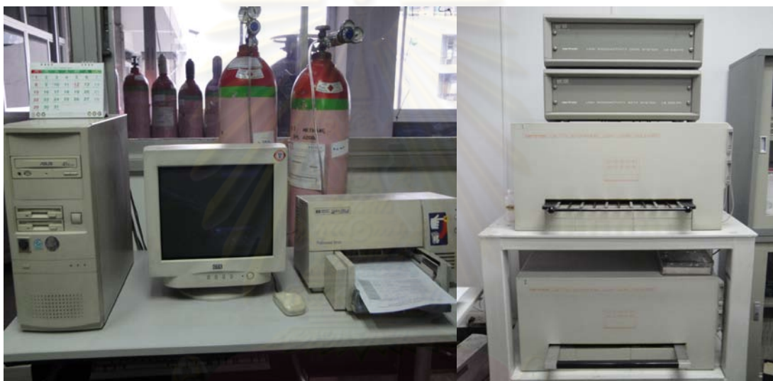
รูปที่ 3.9 ระบบวัดรังสีแอลฟา-ปีตา ระดับแบคกราวด์ต่ำชนิด Gas Flow- Proportional Counter
