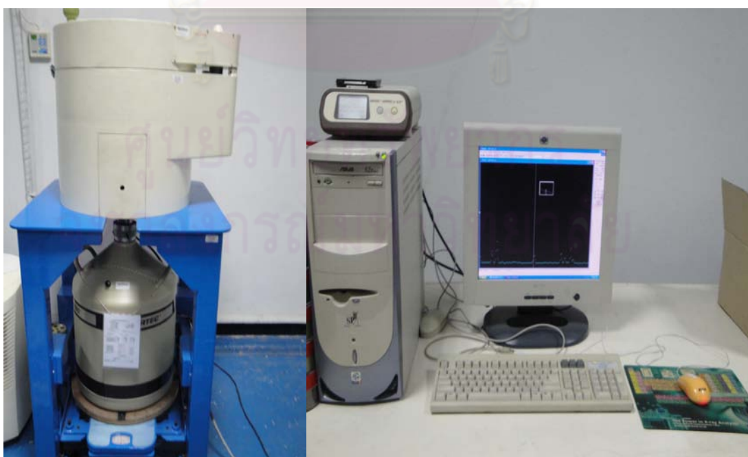
รูปที่ 3.14 ระบบวัดรังสีแกมมาของ Ortec
