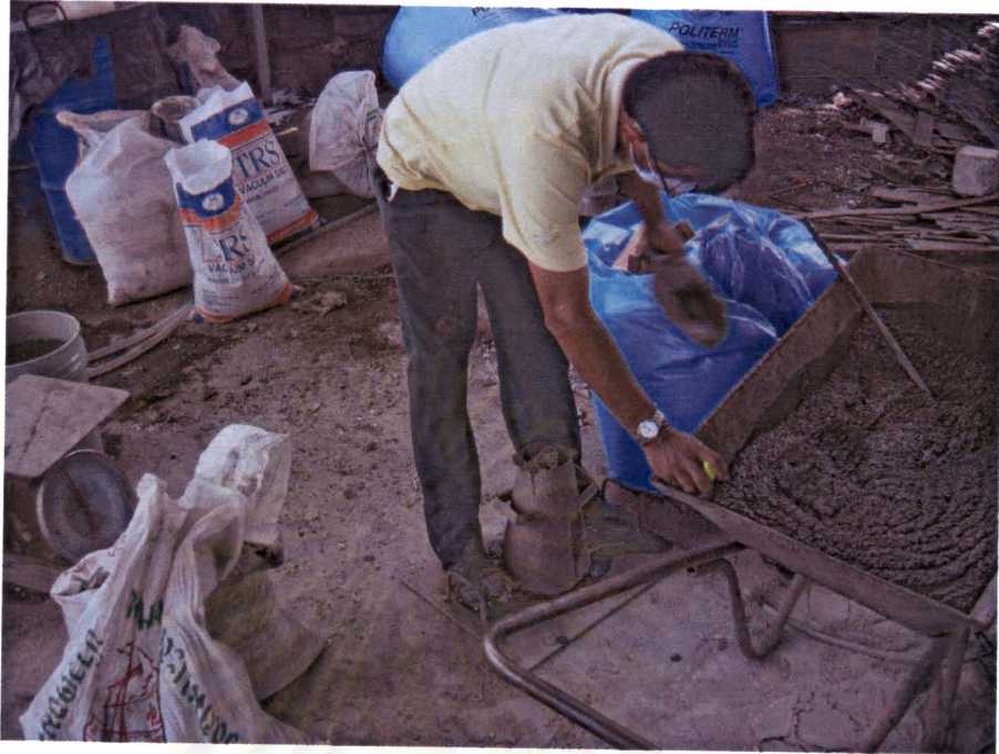
ภาพที่ 8-15 การทดสอบการยุบตัวของโฟมซีเมนต์ (1)
