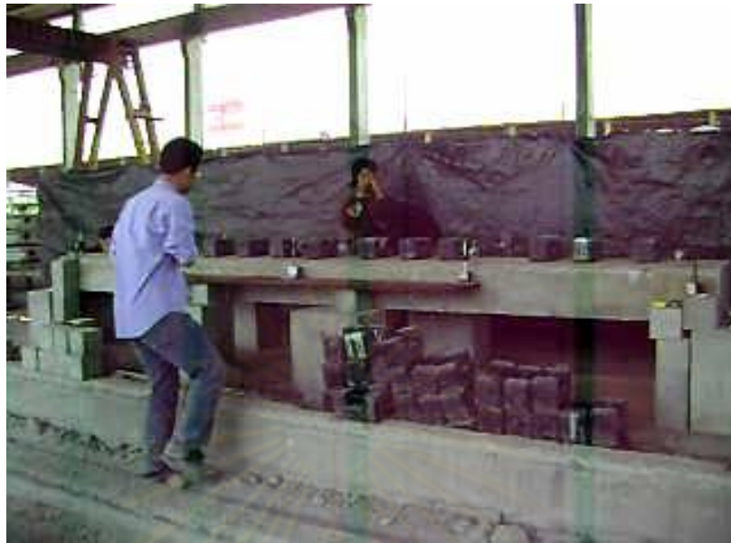
ภาพที่ 4-3 แสดงการจัดเรียงน้ำหนักรรทุก ที่ 25% ของน้ำหนักรรทุกออกแบบ
