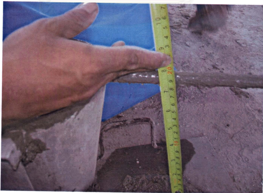
ภาพที่ 8-16 การทดสอบการยุบตัวของโฟมซีเมนต์ (2)
