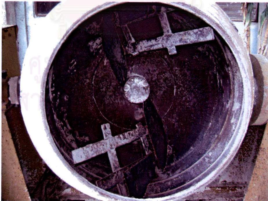
ภาพที่ 8-2 การประยุกต์เครื่องผสมคอนกรีตให้เหมาะสมกับโฟมซีเมนต์
