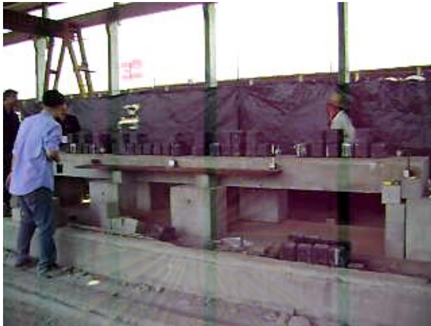
ภาพที่ 4-5 แสดงการจัดเรียงน้ำหนักรรทุก ที่ 75% ของน้ำหนักรรทุกออกแบบ
