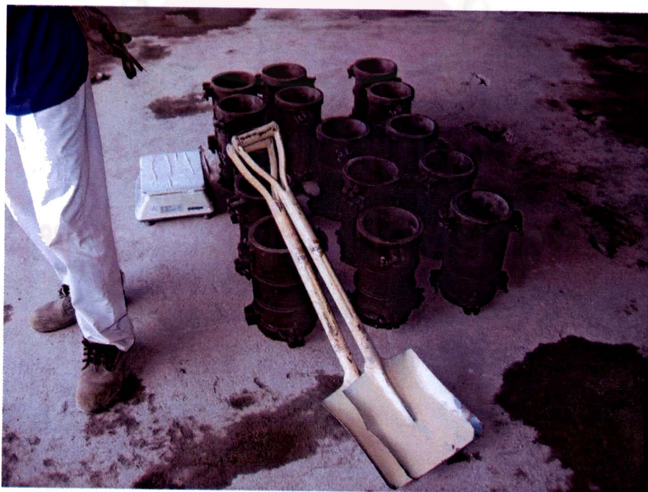
ภาพที่ 8-4 อุปกรณ์การเก็บตัวอย่างทดสอบกำลัง
