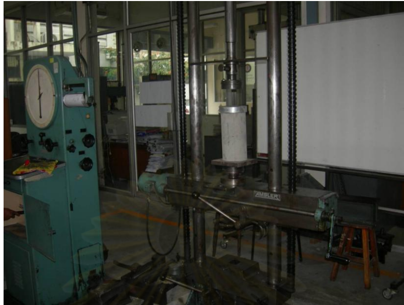
ภาพที่ 4-1 แสดงการทดสอบกำลังรับแรงอัดของตัวอย่างโฟมซีเมนต์
