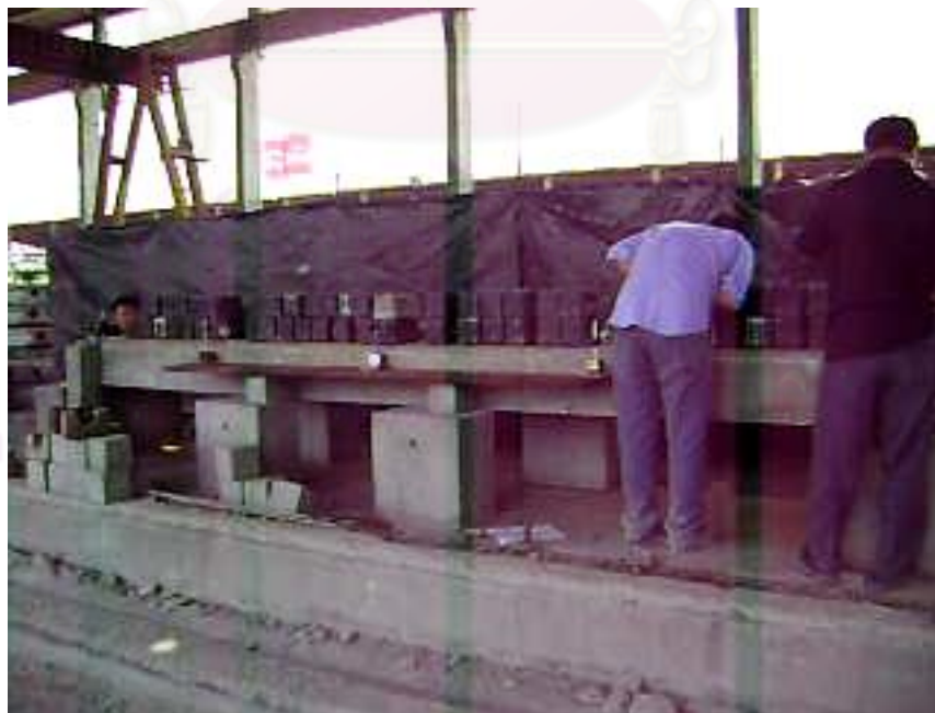
ภาพที่ 4-6 แสดงการจัดเรียงน้ำหนักรรทุก ที่ 100% ของน้ำหนักรรทุกออกแบบ
