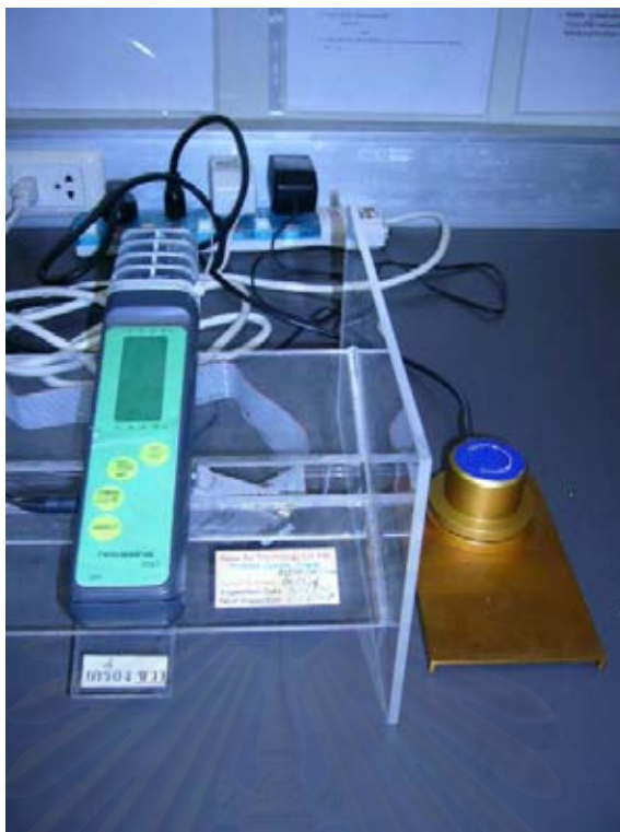
รูปที่ 3.13 เครื่องวัดค่าปริมาณน้ำอิสระ Navsdina's water activity meter, Model MA1aw
