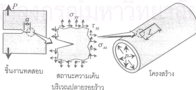
รูปที่ 2.5 การเชื่อมโยงความรุนแรงที่ปลายรอยร้าวจากชิ้นงานทดสอบไปยังโครงสร้าง
