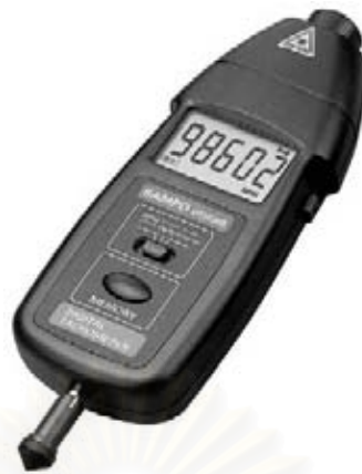
รูปที่ 3.5 เครื่องมือวัดความเร็วมอเตอร์ยี่ห้อ SAMPO รุ่น DT2236B
