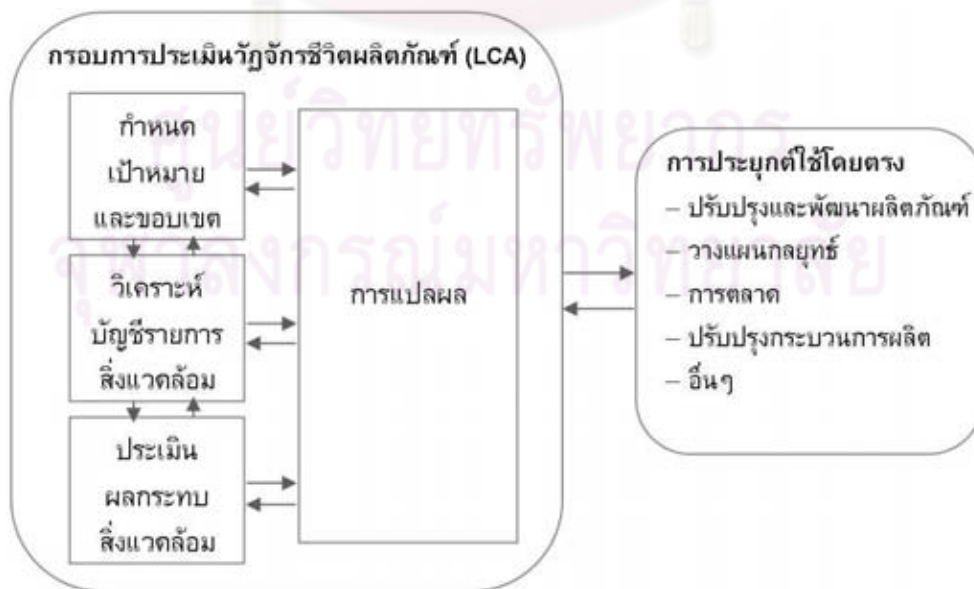
รูปที่ 2.1 กรอบการดำเนินงาน LCA ตามอนุกรมมาตรฐาน 14040 (ISO 14040, 1997)
