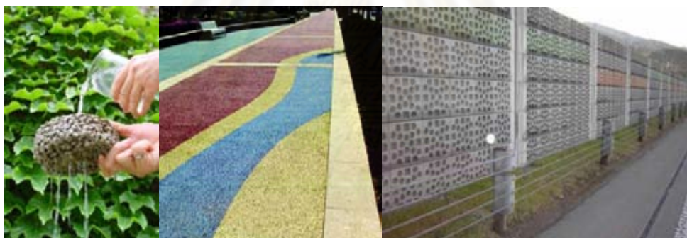
รูปที่ 2.6 คอนกรีตพรุนที่มีความสามารถให้น้ำซึมผ่านได้ นำไปใช้ปูพื้น และกำแพง
