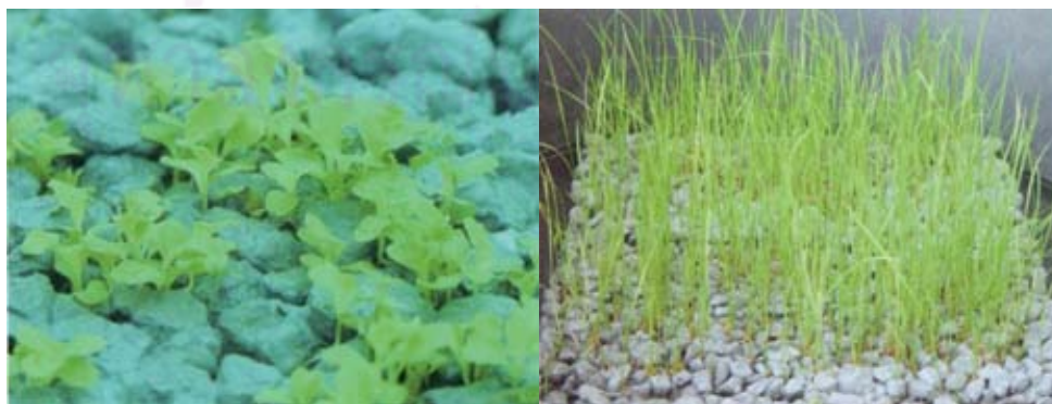
รูปที่ 2.7 คอนกรีตพรุนที่มีรูพรุนทำให้พืชสามารถเจริญเติบโตได้
