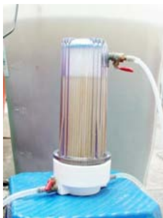
รูปที่ 3.4 ลักษณะและหลักการทำงานของเครื่องกรองแบบแบ่งส่วนที่ใช้ในการทดลอง
