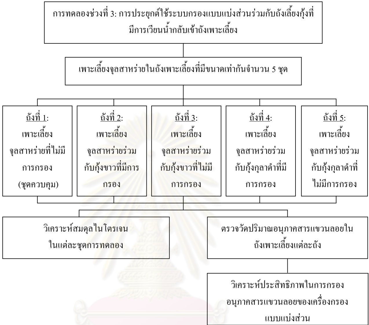
รูปที่ 3.6 แผนผังสรุปการทดลองช่วงที่ 3
