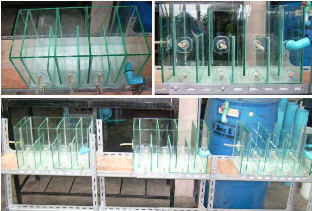
รูปที่ 3.2 แผนภาพและรูปถ่ายถึงปฏิบัติการเอปีอาร์ 3 ชุดที่ใช้ในการทดลองช่วงการทดลองที่ 1
