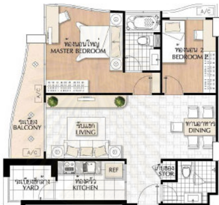
รูปที่ 4.57 แสดงแบบขยาย แบบ 2 ห้องนอน 83 ตารางเมตร
