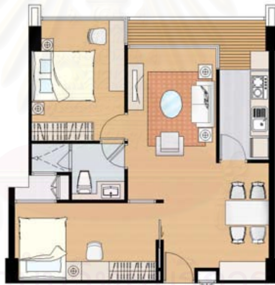
รูปที่ 4.74 แสดงแบบขยายห้องพัก แบบ 2 ห้องนอน ขนาด 60 ตารางเมตร
