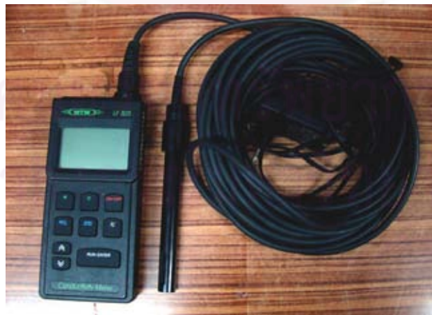
รูปที่ 3-11 เครื่องวัดความนำไฟฟ้า Microprocessor Conductivity Meter
