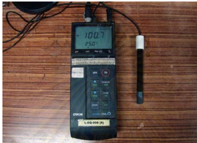
รูปที่ 3-12 เครื่องวัดความเข้มข้นไนเตรท Nitrate Ion Selective Electrode
