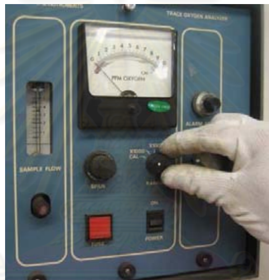
รูปที่ 6.4 แผงควบคุมค่าออกซิเจนของเครื่องเชื่อมส่วนประกอบด้วยความร้อนสูง
