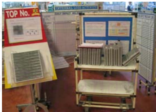
รูปที่ 7.1 การนำงานเสียผลิตภัณฑ์คอยล์เย็นของแต่ละวันมาทำการประชุม
