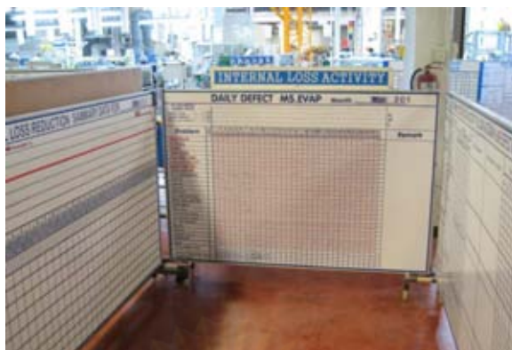
รูปที่ 7.2 บอร์ดบันทึกของเสียที่ใช้ในการประชุมทุกเช้าของทุกวันผลิตภัณฑ์คอยล์เย็น
