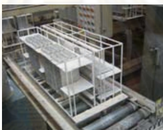
รูปที่ 3.5 การนำชิ้นส่วน Core plate หลังชุบ flux เปียกเข้าเครื่องอบ
