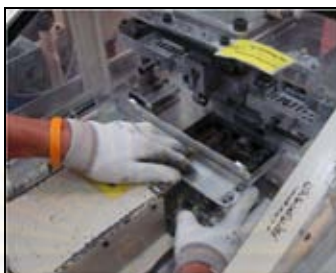
รูปที่ 3.7 กระบวนการประกอบ Inner fin เข้ากับชิ้นส่วน Core plate
