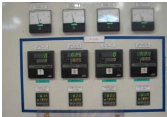
รูปที่ 6.3 แผงควบคุมอุณหภูมิของเครื่องเชื่อมส่วนประกอบด้วยความร้อนสูง
