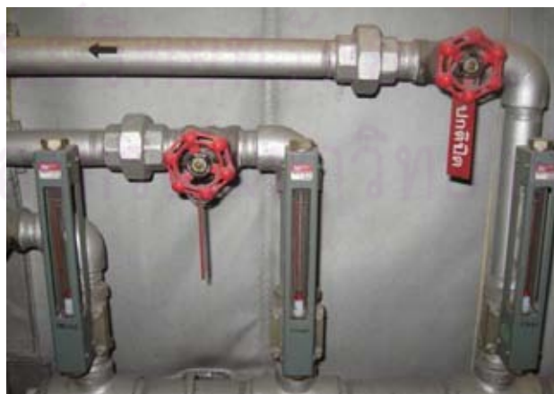
รูปที่ 6.5 ตัวปรับตั้งค่าการจ่ายไนโตรเจนของเครื่องเชื่อมส่วนประกอบด้วยความร้อนสูง
