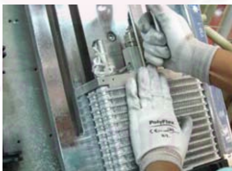
รูปที่ 6.11 ตัวอย่างอุปกรณ์ช่วยในการตรวจสอบชิ้นส่วนในการประกอบที่กระบวนการ Core assembly
