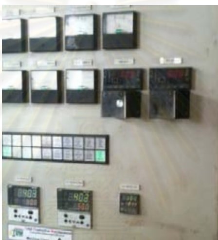
รูปที่ 6.6 แผงควบคุมของเครื่องระเหยน้ำมันออกจากชิ้นส่วน Core plate
