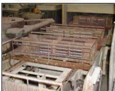
รูปที่ 3.3 กระบวนการระเหยน้ำมันออกจากตัวงาน Core plate
