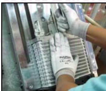
รูปที่ 3.8 กระบวนการประกอบ Core assembly
