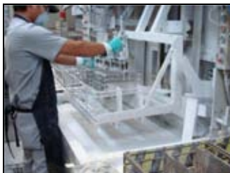
รูปที่ 3.4 การนำชิ้นส่วน Core plate ชุบลงน้อ flux เปียก
