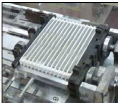
รูปที่ 3.9 ชิ้นงานที่ถูกอุปกรณ์จับยึดบังคับตำแหน่งของชิ้นส่วนต่างๆ
